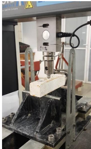
Figura 4.12-Esquema de ensaio da dureza superficial
