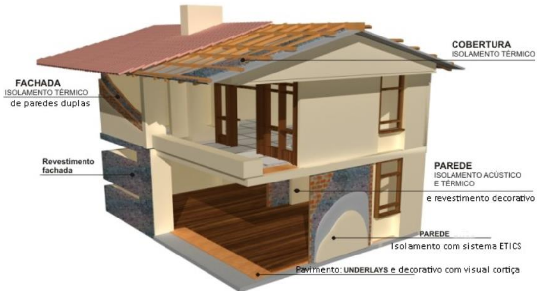
Figura 2.7-Aplicação em uma habitação (APCOR, 2018)
