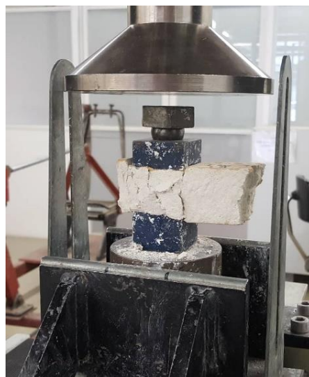
Figura 5.10-Provete com fibras após rutura
