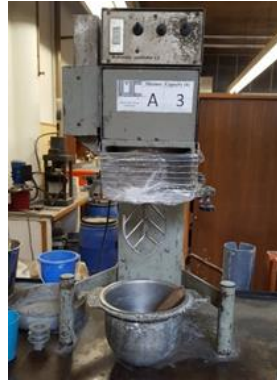
Figura 3.1-Misturadora utilizada na amassadura
