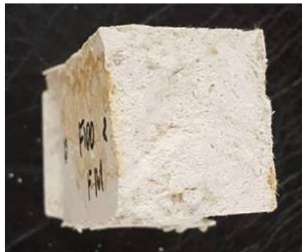
Figura 5.5-Provete de gesso e fibra moída
