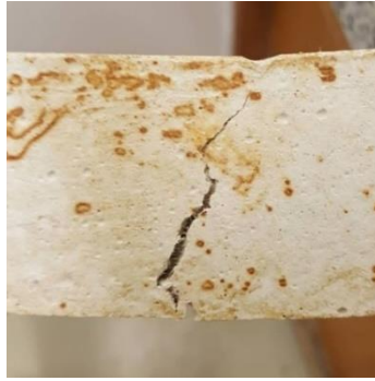
Figura 5.6-Provete de fibra moída depois do ensaio
