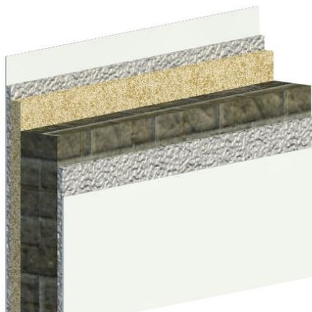
Figura 32. Pared de la envolvente interior con aislamiento.
