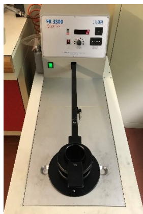
FIGURA 20: APARELHO PERMEABILIDADE AO AR
