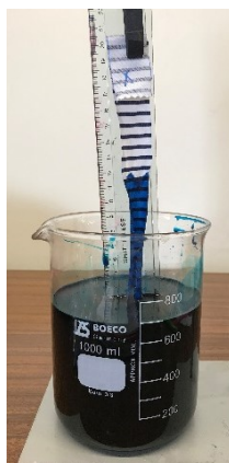
FIGURA 18: ENSAIO WICKING VERTICAL
