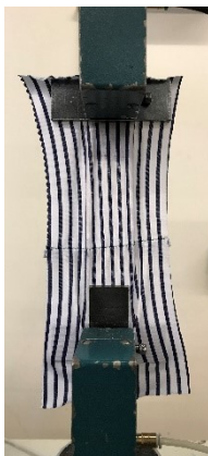
FIGURA 15: DINAMÓMETRO ROTURA DA COSTURA
