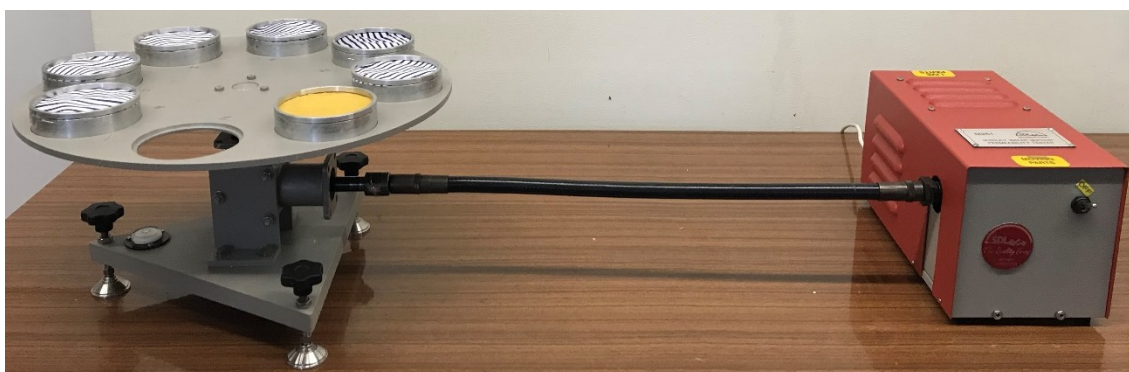
FIGURA 19: ENSAIO PERMEABILIDADE AO VAPOR DE ÁGUA
