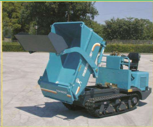
Frontal dumping skip with (without) selfloading shovel / Pritsche mit frontaler Kippung mit / ohne Selbstladeschaufel /
