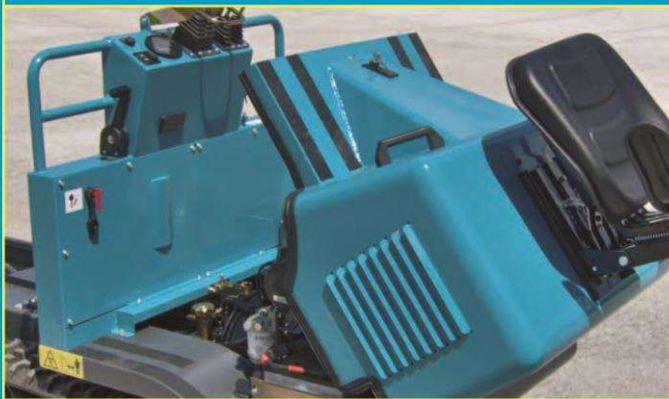
Easy access engine bonnet / Motorhaube für vereinfachte Wartung /
