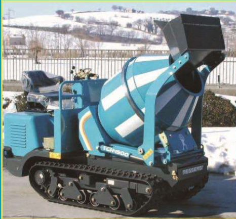
TCH-1500/BET with concrete mixer of 0,36 m³ output capacity / TCH-1500/BET mit Betonmischeinheit mit 0,36 m³ Fassungsvermögen / TCH-1500/BET
