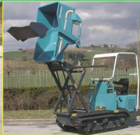
High tip skip with (without) selfloading shovel Pritsche mit Entladung in variabler Höhe mit / ohne Selbstladeschaufel
