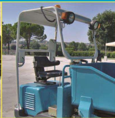
ROPS-FOPS canopy (for on road use also) / Schutzdach ROPS-FOPS mit Strassenzulassung /
