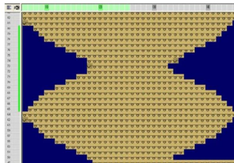
Figura 51 – 3D forma esférica – aspeto do têxtil e programa de desenho de malha. Fonte: (Ionesi & Ciobanu, 2010).
