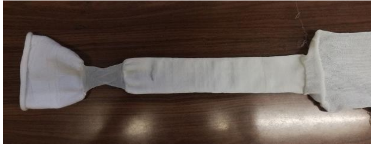
Figura 48 – Teste realizado no tear circular com diferentes tipos de fios.
