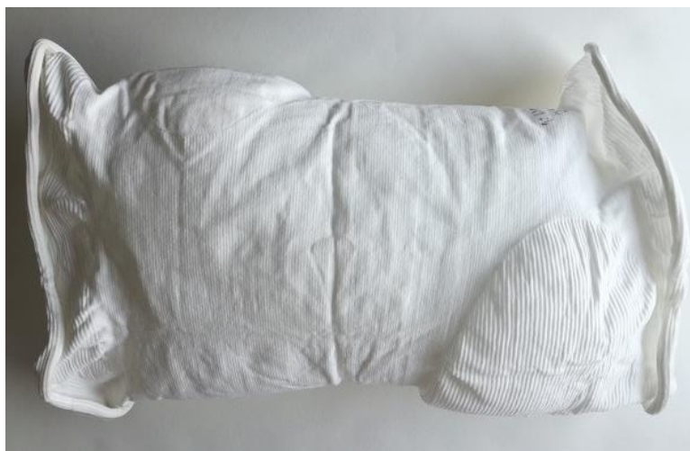
Figura 57 – Malha com inclusão de saco de fruta com ar.
