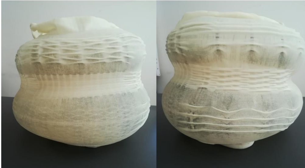
Figura 67 – Resultado da resina aplicada na malha com estruturas 3D na superfície.
