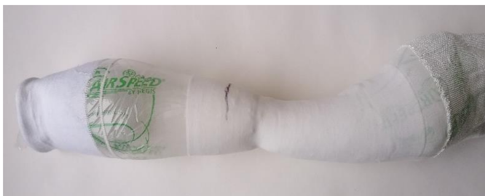
Figura 58 – Amostra realizada no tear circular de amostra com sacos de ar no interior.
