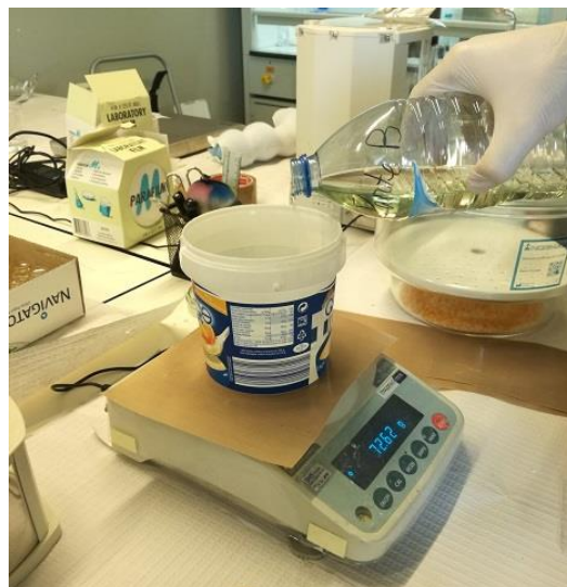
Figura 62 – Mistura de componentes para obtenção do Epoxi
