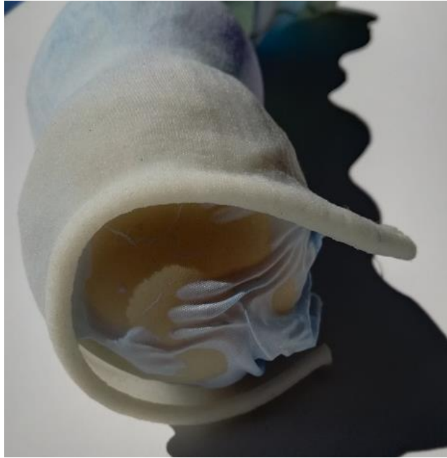
Figura 65 – Malha com resina antes de secar.
