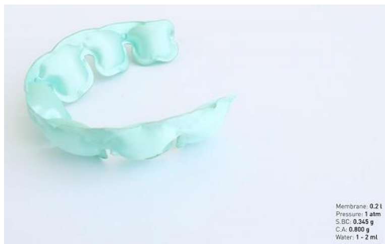
Figura 22 – Estrutura autoinsuflável com descrição das características. Fonte: MIT, 2019
