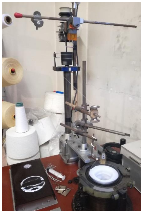
Figura 47 – Tear circular com sistema de agulhas de came fixa de propriedade da Uni. do Minho.
