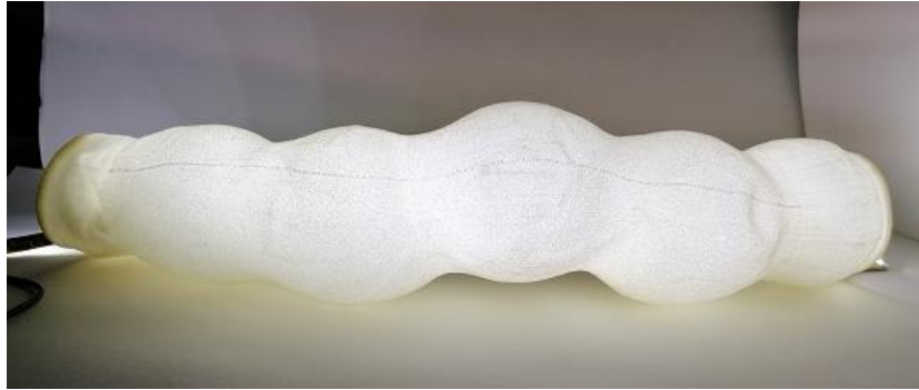
Figura 76 – Protótipo com inclusão de LED no seu interior.
