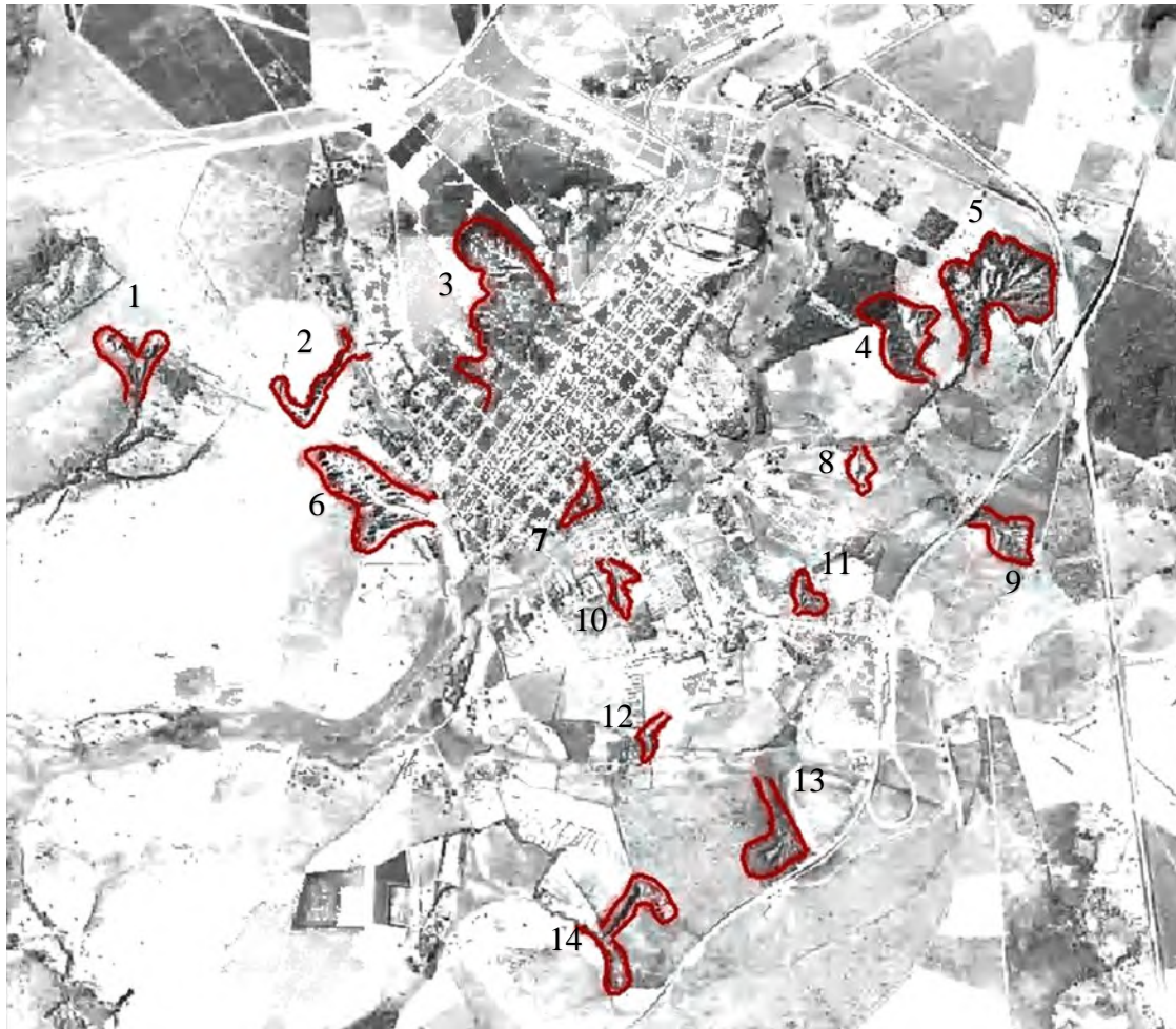
Figura 6 - Processos de erosão hídrica do tipo ravina e boçoroca no ano de 1965. Numeração baseada em IPT/2019. Fonte: Acerto IPT.
