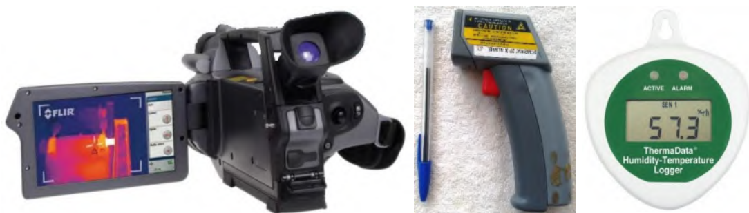
Figura 2. Câmera termal FLIR SC660, Termômetro Infravermelho Raytek e termo-higrômetro ETI, respectivamente. Fonte: FLIR, Mendes e ETI
