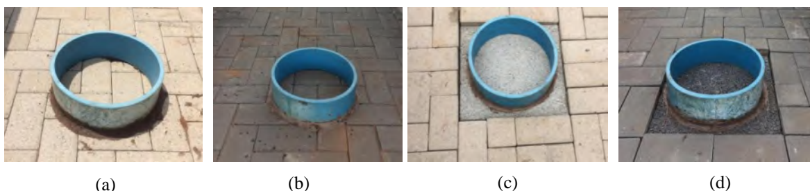
Fig. 5 Pavimentos com cilindro para ensaio de permeabilidade
