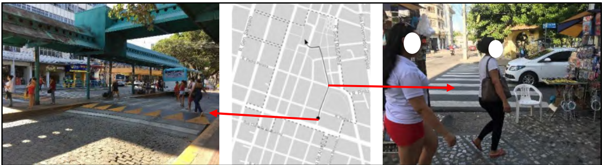
Fig. 7 Faixas elevadas na estação de ônibus e faixa de pedestre entre esquinas
