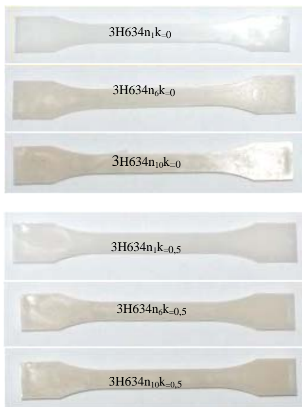
Figura B.2 - Variação da cor com o número de ciclos de processamento – PEAD 3H634
