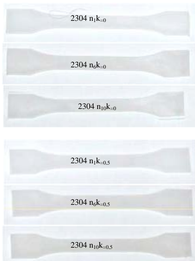
Figura B.4 - Variação da cor com o número de ciclos de processamento – PEBD 2304
