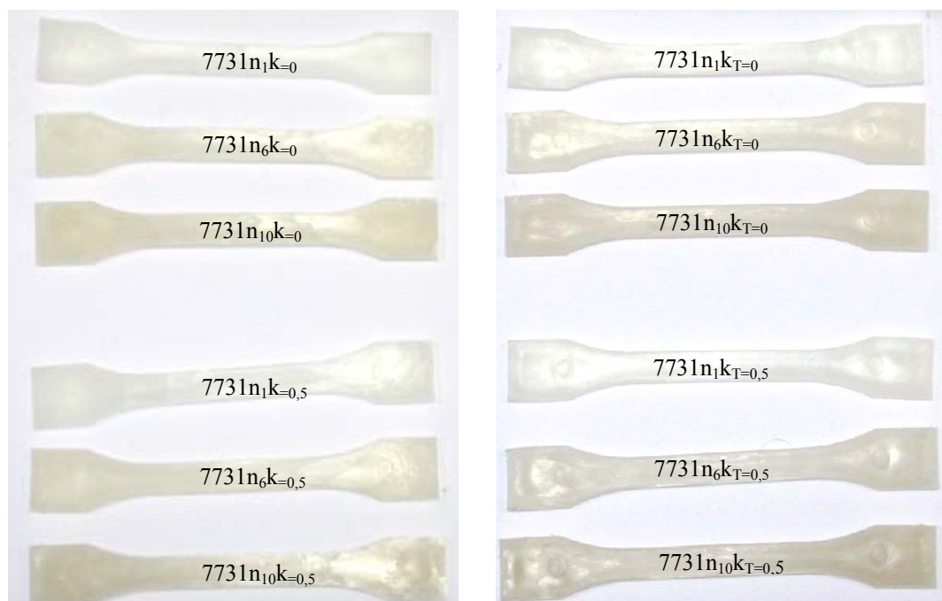
Figura 4.7 – Variação da cor com o número de ciclos de processamento - PEAD 7731
