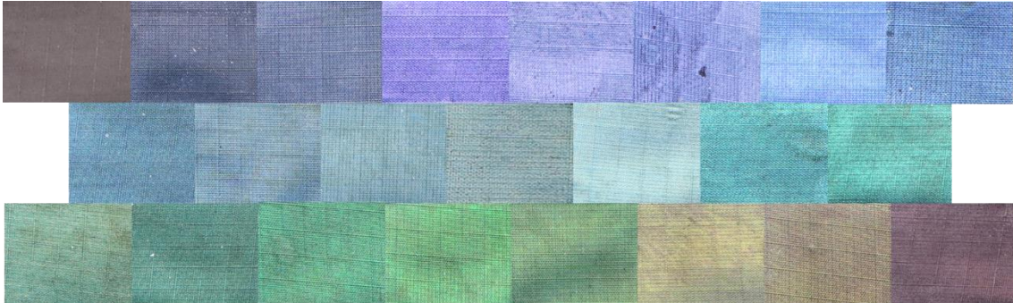
Figura 8 - Diferentes cores obtidas com o método de dip-drawing . PA não revestida (canto superior esquerdo) e PA revestida com várias cores estruturais, violetas ( \approx 170 nm), azuis ( \approx 190 nm), verdes ( \approx 210 nm), amarelos ( \approx 230 nm) e vermelhos ( \approx 250 nm) (canto inferior direito).
