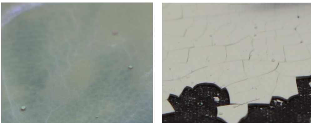
Figura 6 - Deposição por sedimentação gravitacional utilizando a suspensão coloidal da mistura reacional.
