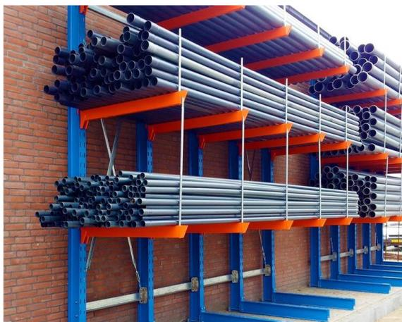
Figura 3 - Sistema de armazenamento do tipo rack cantilever (Fonte:Nortemonta).
