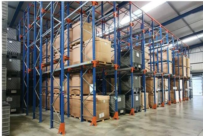
*Figura 2 - Sistema de armazenamento do tipo drive-in (Fonte:Lusoracks).*
