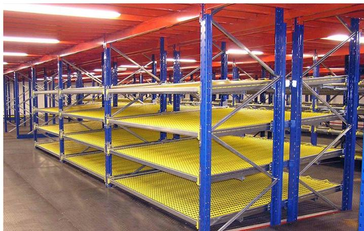
Figura 4 - Sistema de armazenamento do tipo rack gravitacional (Fonte:Nortemonta).
