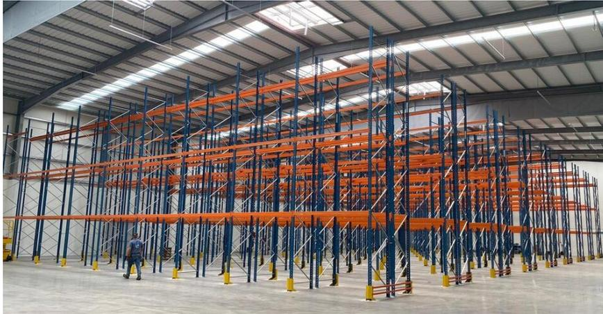
*Figura 1 - Sistema de armazenamento do tipo rack convencional (Fonte:Lusoracks).*
