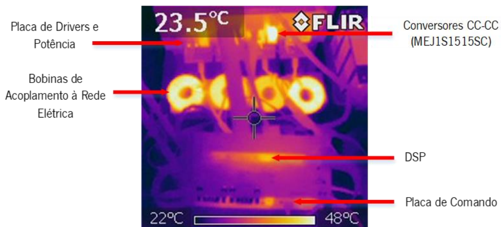
Figura 5.28 Resultado experimental da distribuição da potência dissipada nos diversos pontos do sistema.
