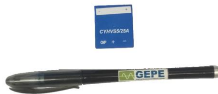
Figura 4.5 Sensor de Tensão - CYHVS5-25A.
