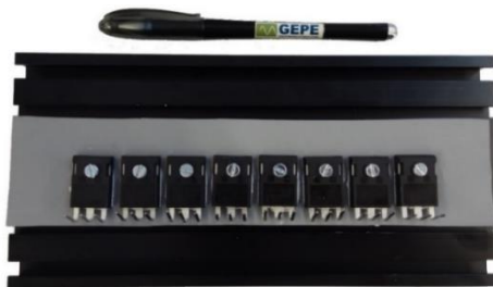
Figura 4.18 Dissipador e semicondutores fixados com uma pressão uniformemente distribuída.
