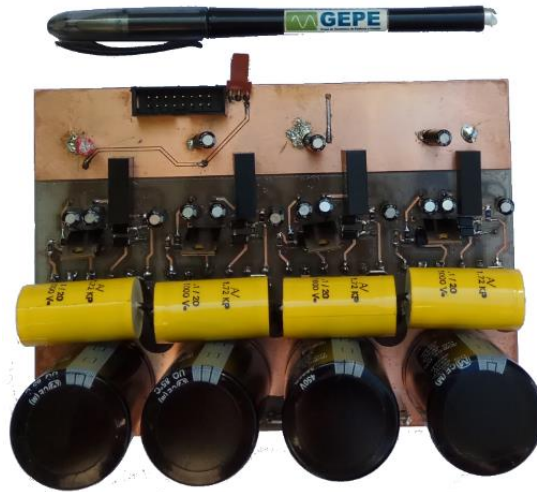
Figura 4.15 Primeira versão da PCB de drivers e potência.
