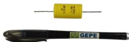
Figura 4.23 Condensador de desacoplamento.
