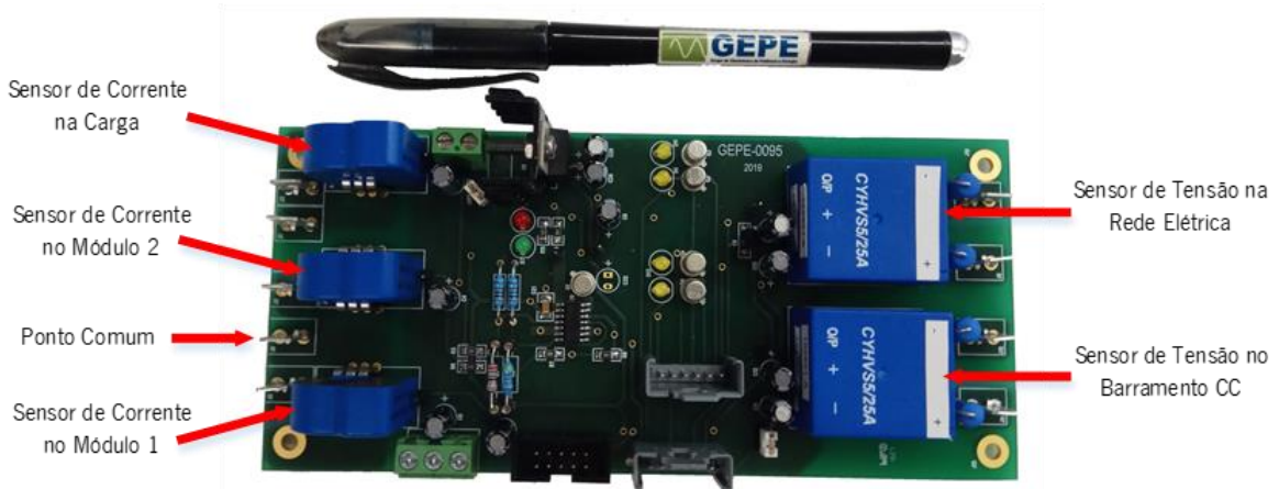
Figura 4.3 PCB do sistema de controlo – Parte superior.
