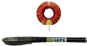
Figura 4.25 Bobina com núcleo de pó de ferro utilizada para acoplamento à rede elétrica.
