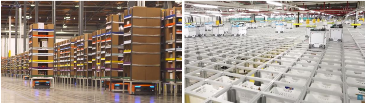
Figura 42. Armazéns semi-autónomos das empresas Amazon (Amazon Robotics, 2019) e Ocado (Ocado Technology, 2019)
