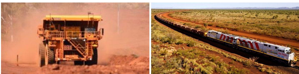
Figura 36. Camião autónomo na mina de ferro de Yandicoogina e comboio autónomo em operação no oeste da Austrália (Rio Tinto, 2019)
