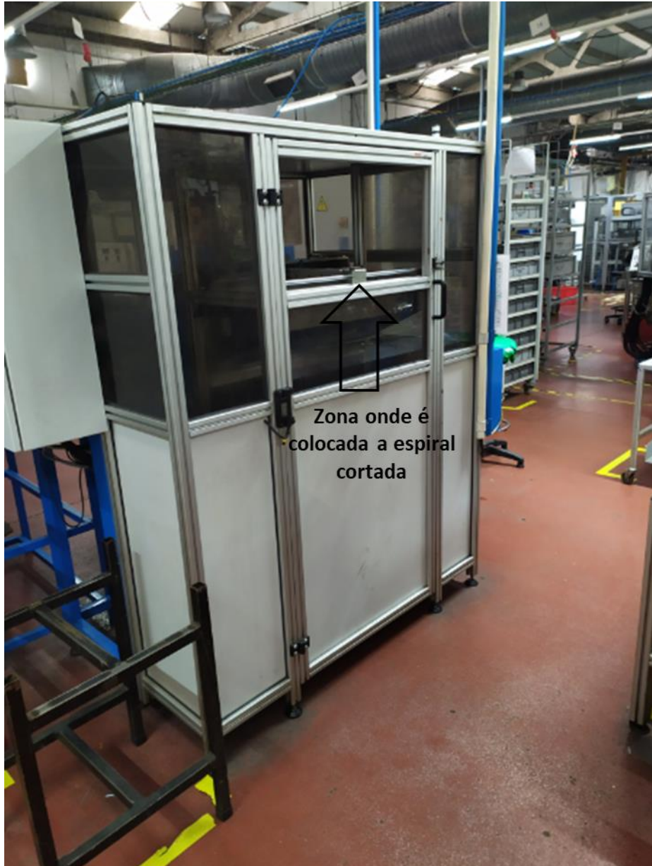
Figura 12 - Máquina de escarear e esmerilar vista de frente. Por aqui coloca-se a espiral cortada
