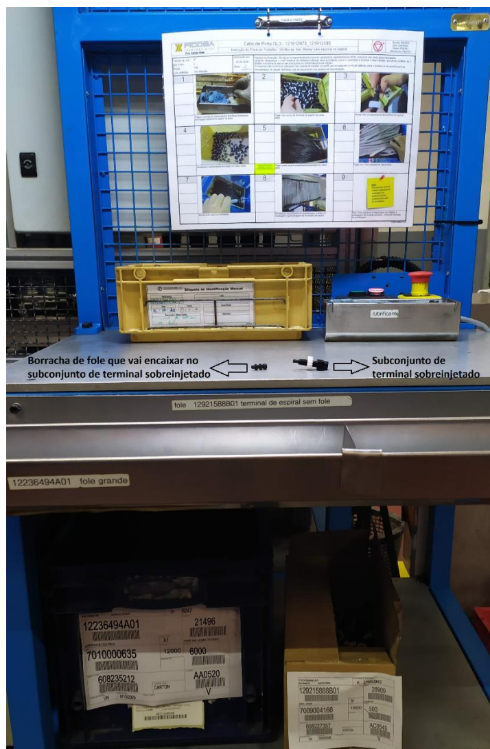
Figura 15 - Posto de trabalho encarregue de inserir a borracha de fole no subconjunto
