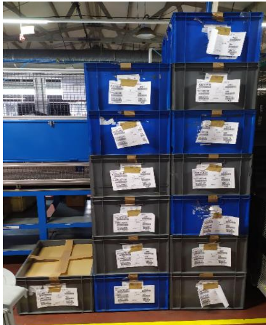
Figura 29 - Exemplo de inventário excessivo nas linhas de montagem GL3
