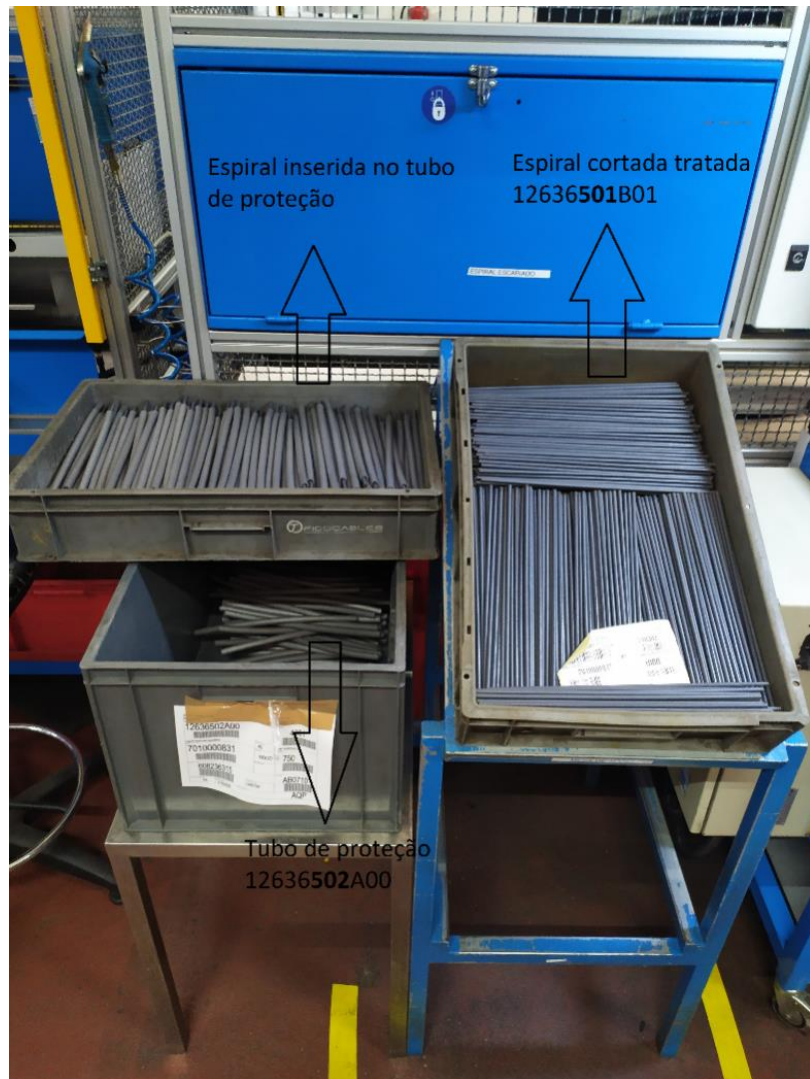
Figura 14 - Posto de trabalho responsável pela inserção da espiral cortada no tubo de proteção
