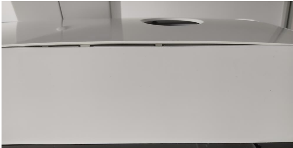
Figura 73- Empeno da peça do ensaio 11
