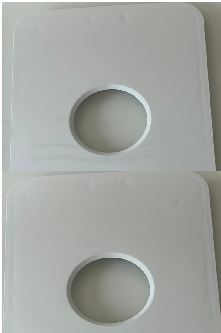
Figura 78-Chupados das peças dos ensaios 10 e 16
