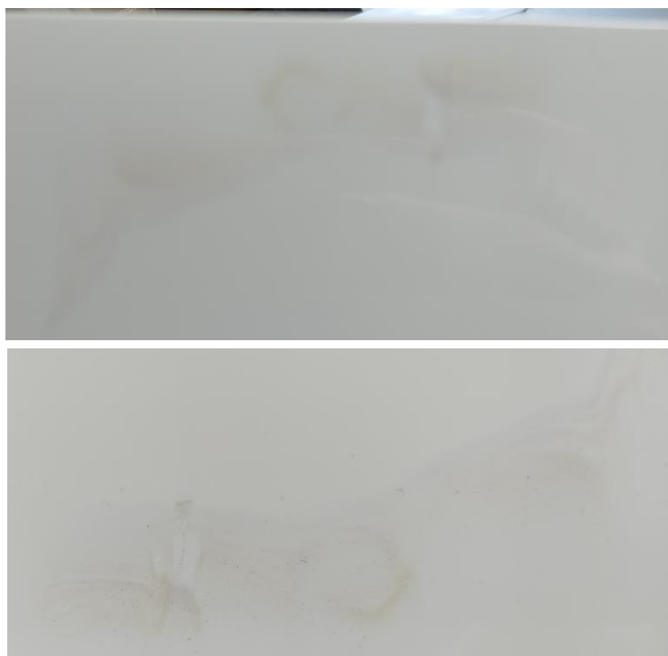
Figura 79- Queimados das peças dos ensaios 7 e 15
