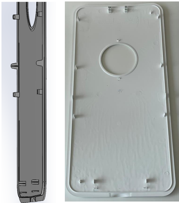
Figura 17-Engates e castelos da parte de trás da peça
