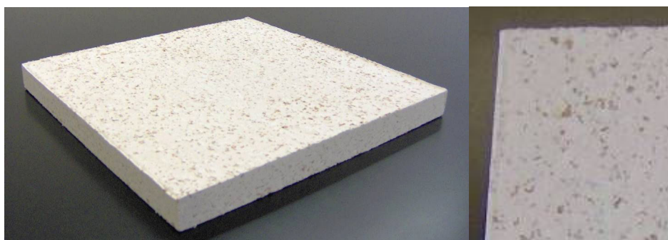
Figura 7 – Placa de gesso prensado com adição de pasta de papel e cortiça e a sua textura (P2a).
