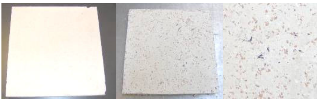
Figura 6 – Placas de gesso prensado (P0) e gesso com adição de cortiça e fibras têxteis (P4a) e a sua textura.
