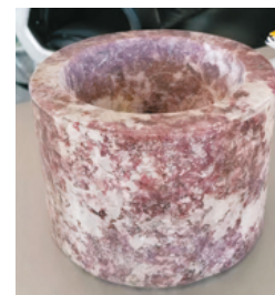
Figura 15 Maquinação 1 aplito-pegmatito lepidolítico sem tratamento de consolidação com resina (14Ø) (Material cedido por José Aldeia Lagoa e Filhos, ensaios realizados na empresa Mármore e Granitos Transmontanos.)
