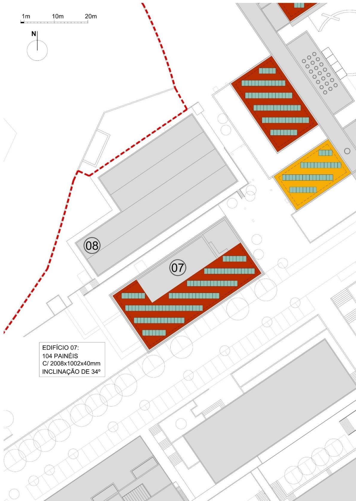
Figura 4-10 - Disposição dos painéis - Edifício 7.
