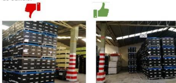
Figura 2 – Altura permitida de empilhamento de paletes
