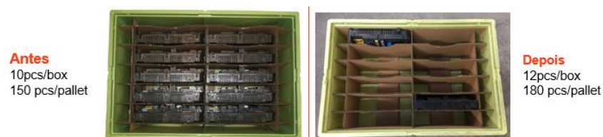
Figura 72- Reestruturação do interior das caixas 4322
