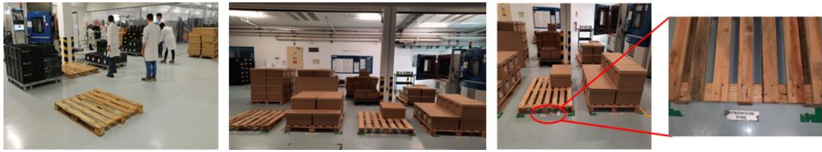
Figura 113- Reestruturação do layout da zona de embalagem e marcações visuais no piso
