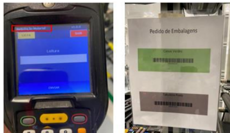
Figura 42- Leitor do posto de pedidos de kanban e folha para pedidos de embalagem
