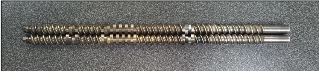
*Figura 17- Parafusos da mini extrusora constituídos por diferentes elementos de mistura e transporte.*
