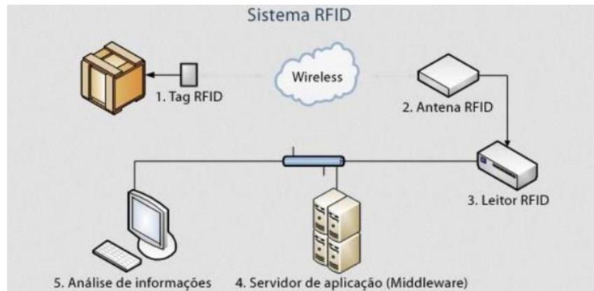
Figura 5 - Arquitetura de um sistema RFID
