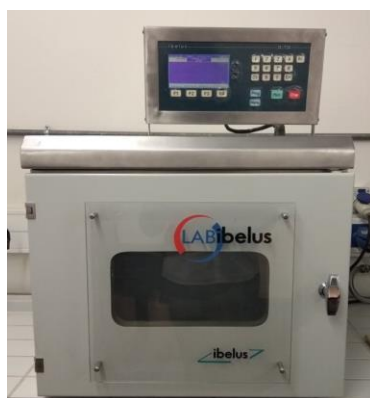
Figura 19 - Fotografia da máquina de tingir Ibelus IL-720 (1 amostra) (Fonte: Autora)
