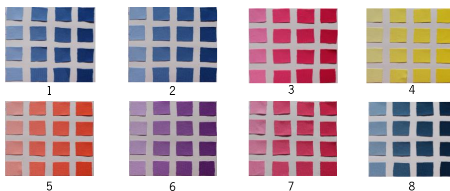
Figura 35 - Fotografias das malhas tingidas Esquerda para a direita concentrações: 0.1%, 0.5%, 1.0% e 2.0%; Cima para baixo: as malhas Jersey 2372, Jersey1453, Jersey 2398 e Rib 1014. (Fonte de luz: lâmpada D65) (Fonte: Autora)
