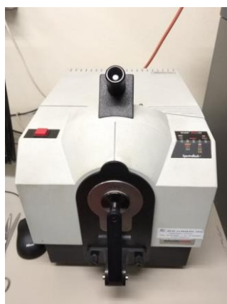
Figura 26 - Fotografia espectrofotômetro Datacolor Spectraflash SF 600 Plus CT (Fonte: Autora)
