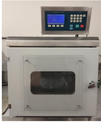
Figura 20 - Fotografia da máquina de tingir Ibelus C-720 (12 amostras) (Fonte: Autora)
