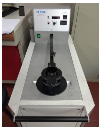
Figura 28 - Fotografia permeabilímetro de ar TEXTEST FX 3300 (Fonte: Autora)
