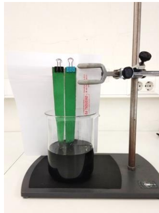
Figura 29 - Estrutura para realização do ensaio de Dispersão Vertical (Wicking vertical) (Fonte: Autora)
