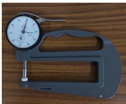
Figura 17 - Medidor de espessura manual analógico Mitutoyo (Fonte: Autora)
