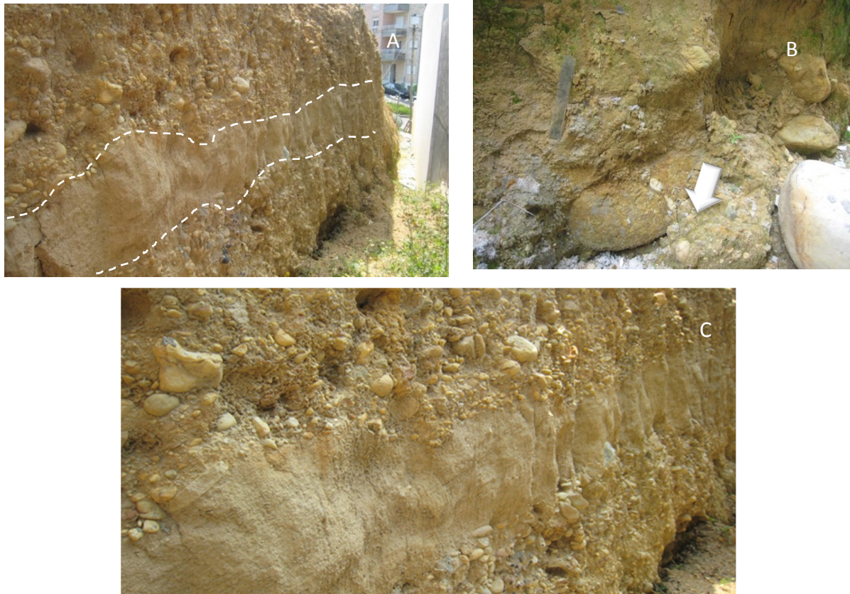
Fig. 4.15. Depósito da Encosta do Douro. A - Aspeto geral. B - Blocos de grandes dimensões dispersos numa matriz de areia e argila, na base do terraço. A seta assinala a presença de um bloco arredondado de natureza conglomerática entre outros maioritariamente quartzíticos (a régua da imagem mede 20 cm). C - Estrutura de canal.
