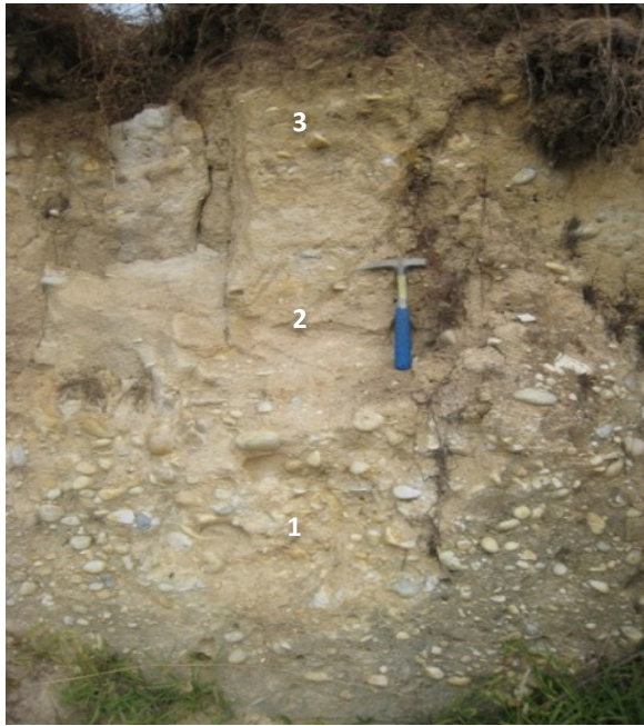
Fig. 4.22. Aspeto geral do depósito de Fisga na rua Trás da Agra. 1. Nível constituído pela litofácies Gm, 2. Litofácies Sl, 3. Nível constituído pela litofácies Gp.
