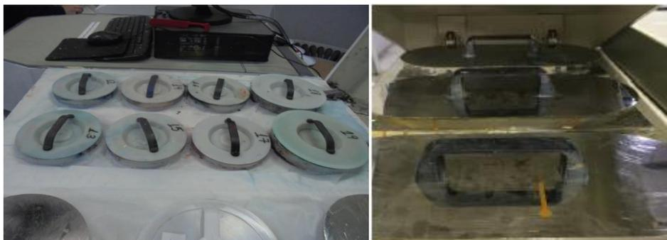
Figura 19 - Situação inicial dos depósitos de corantes presentes nas máquinas
