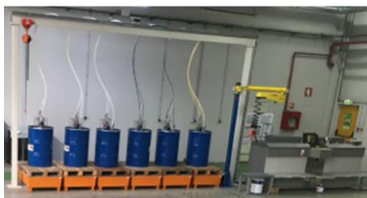
Figura 28 - Estação de doseamento com depósitos externos
