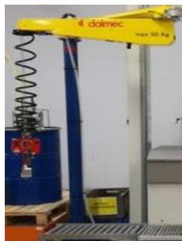
Figura 26 - Manipulador pneumático
