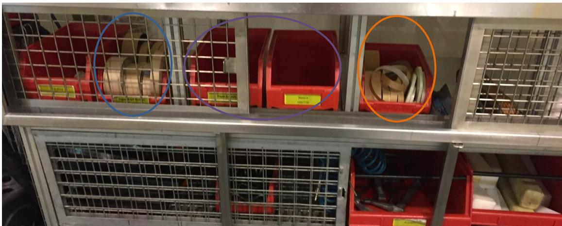
*Figura 38 - Materiais do posto de Formação de Fases com identificação indevida*
