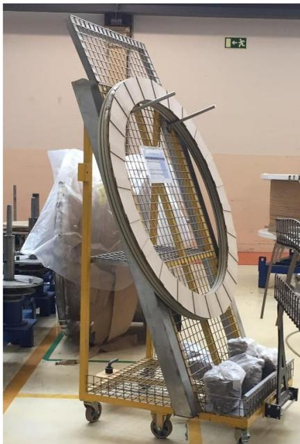
Figura 30 - Kit dos Isolantes utilizado no posto de Bobinagem AT
