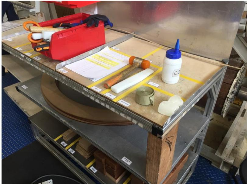
*Figura 42 - Bancada de trabalho com marcações do local de cada material*
