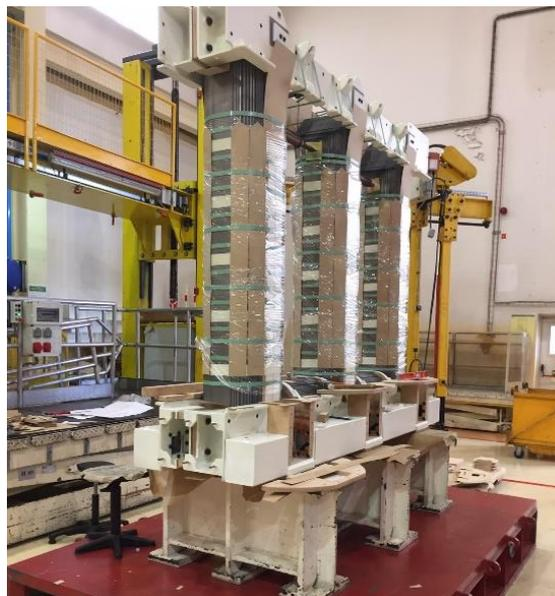
*Figura 18 - Posto de Montagem da Parte Ativa*
