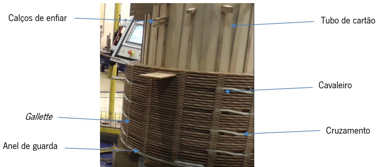
Figura 12 - Pormenor de uma bobina AT
