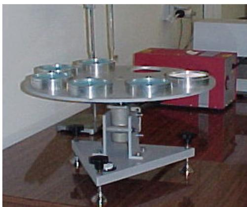
Figura Al.10 – Instrumento para Medir a Permeabilidade ao Vapor de Água (da Shirley)
