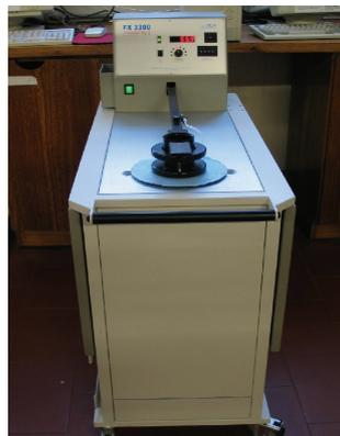
Figura Al.12 - Permeabilímetro TEXTEST FX 3300 - III
