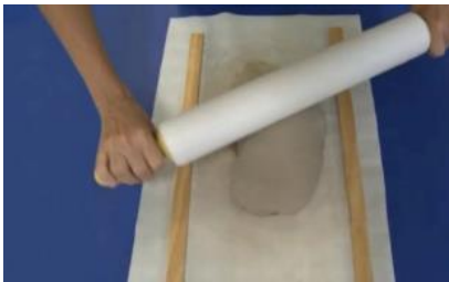
Figuras 65 e 66 - Etapas de abertura de uma placa de argila a partir da ação de um rolo de pizza sobre um bloco desta argila.
