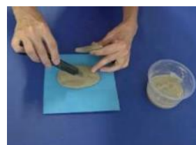
Figura 62 - Execução de ranhuras
