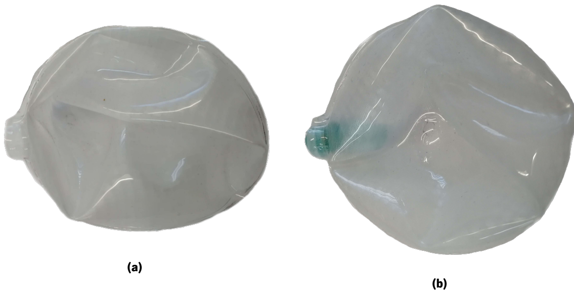
Figura 4.10: Imagem real do balão fabricado: a) balão em PDMS, b) balão em PDMS em torno da cápsula.
