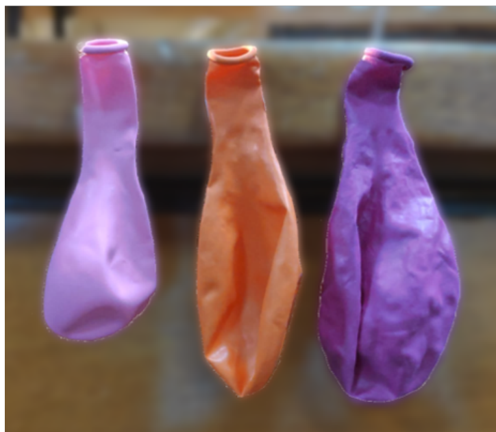
Figura 4.3: Balões comerciais utilizados nos ensaios de insuflação com ar: balão novo (esquerda), balão insuflado durante um dia (centro), balão insuflado durante três dias (direita).
