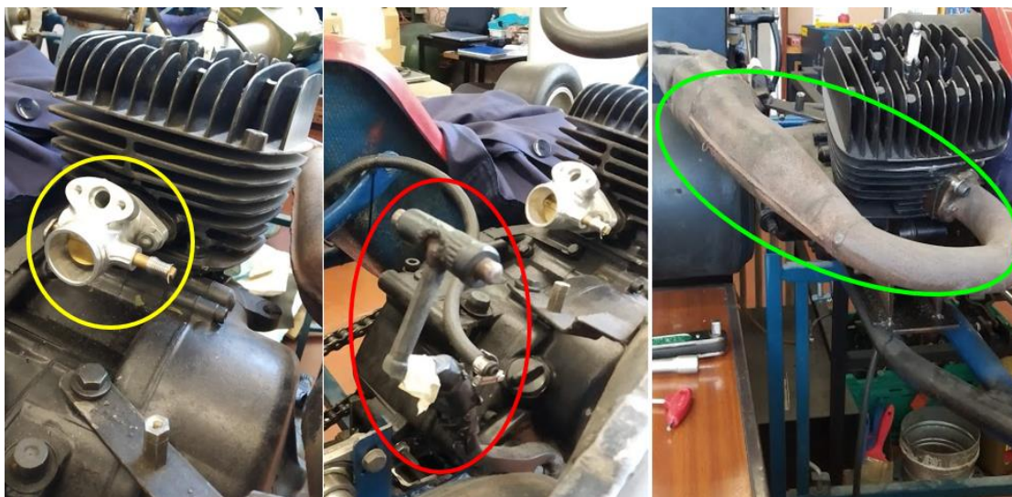
Figura 66. Motor Suzuki em setembro de 2019. A amarelo representado o coletor de admissão, a vermelho o "kicks" e a verde o tubo de escape.
