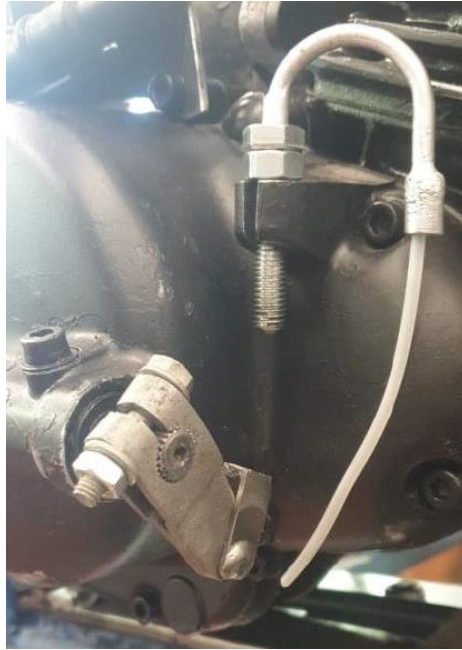
Figura 78. Fotografia do estriado da alavanca de velocidades de um motor zundapp inserido na embraiagem do motor, com afinador.
