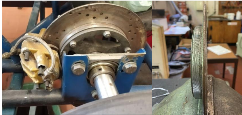
Figura 80. Fotografias do disco do travão inicial empenado.
