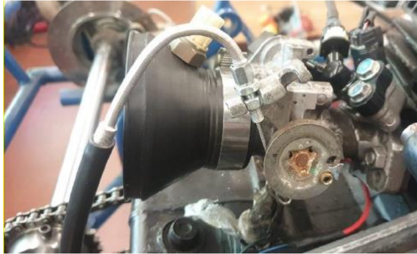
Figura 71. Fotografia com o terminal em forma de u e afinador no corpo da borboleta.
