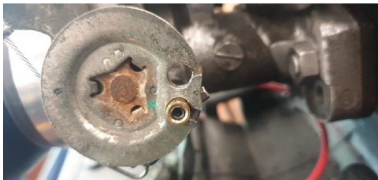
Figura 70. Fotografia do “serra-cabos” inserido no corpo da borboleta.
