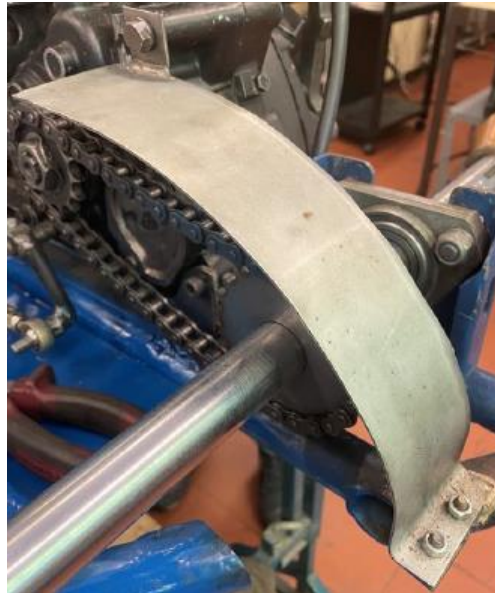
Figura 95. Fotografia da chapa de proteção da corrente.
