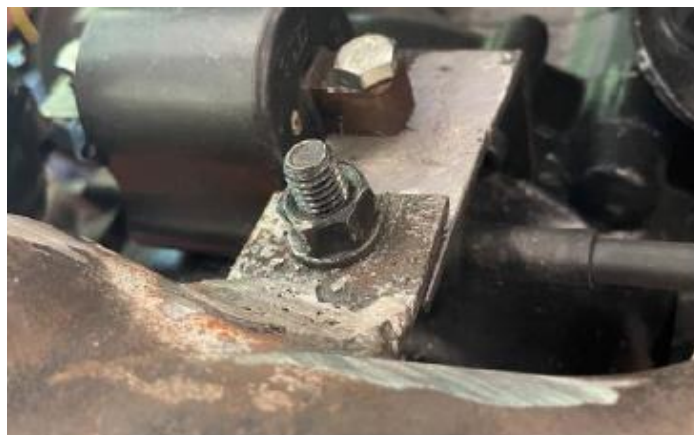
Figura 94. Fotografia do apoio do escape no suporte da bobine.
