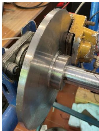
Figura 81. Fotografia do disco do travão montado no veio e pinça.
