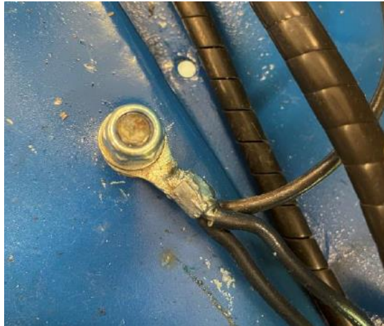
Figura 89. Fotografia do ponto de massa criado na chapa de proteção da base.
