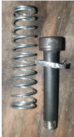
Figura 82. Fotografia das molas antirruído adicionadas na pinça do travão.
