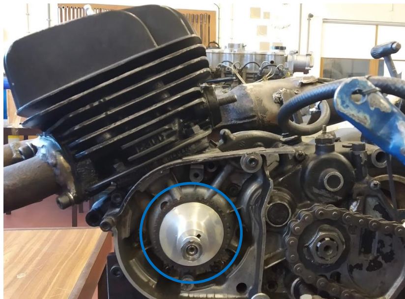
Figura 69. Fotografia do motor onde se pode observar o disco dentado, circundado a azul, responsável por indicar a posição da cambota.
