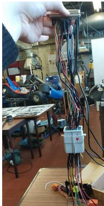
Figura 55. Fotografia da ficha DB 37 com os fios soldados, seguida de uma ficha macho-fêmea (segurança) com os fios igualmente soldados.
