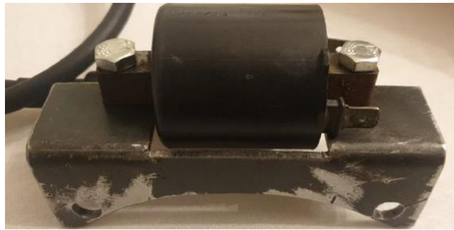
Figura 77. Fotografia do suporte desenhado e fabricado para a bobine.
