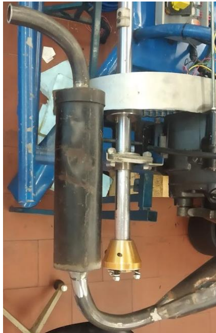
Figura 93. Fotografia do escape após a correção do ângulo de curvatura.
