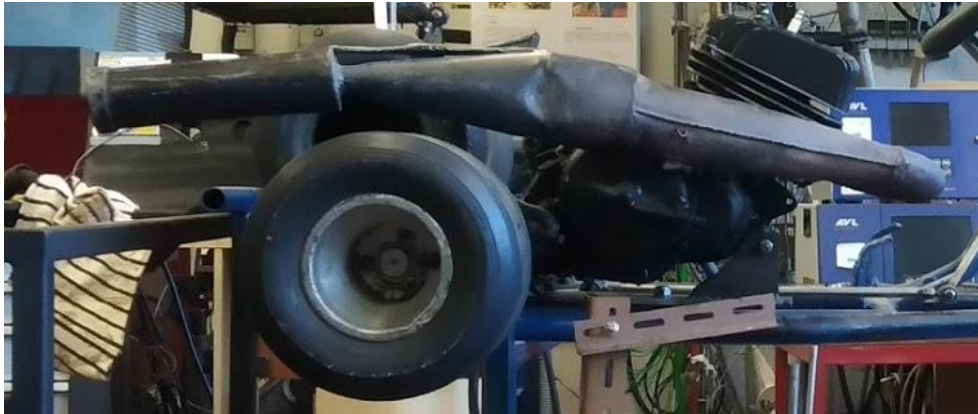
Figura 68. Fotografia do escape montado inicialmente.
