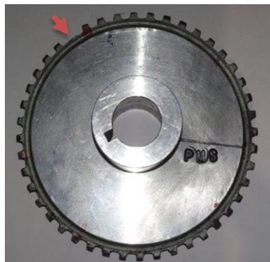
Figura 83. Fotografia da roda dentada da cambota com 44 dentes.
