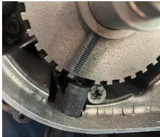
Figura 84. Fotografia da roda dentada com a falha do dente e o sensor de posição.
