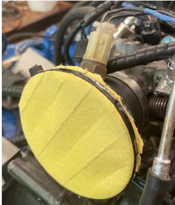
Figura 75. Fotografia do suporte maquinado para o filtro e posicionamento do sensor de temperatura do ar de admissão.
