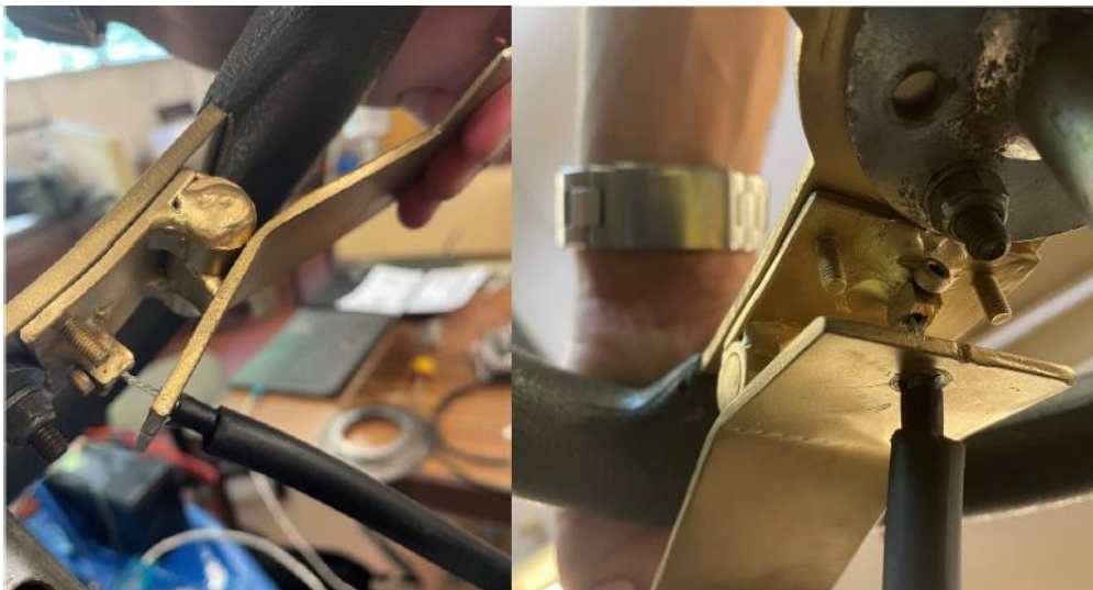
Figura 79. Fotografias da manete tipo patilha fixada num dos braços do volante.
