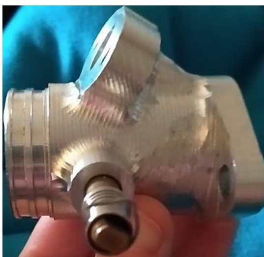
Figura 67. Fotografia do coletor de admissão inicial em alumínio, desenvolvido nos laboratórios do DEM.
