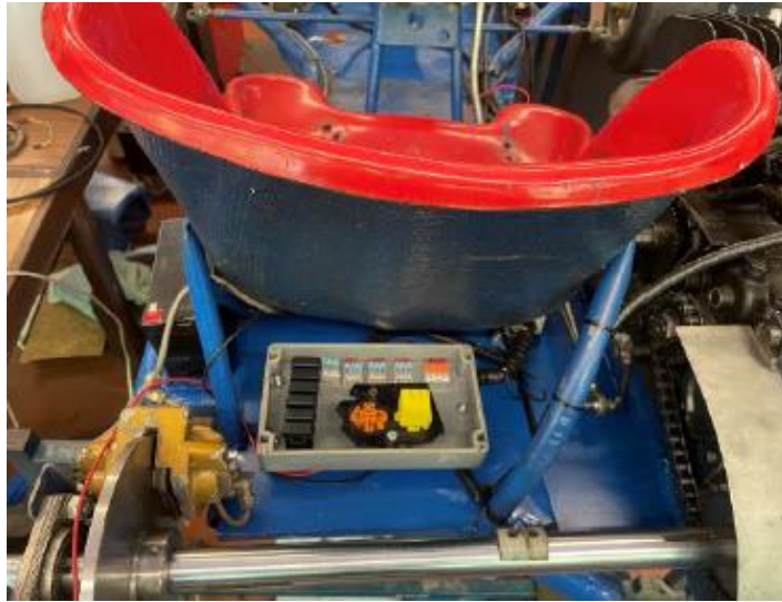
Figura 91. Fotografia da caixa de relés e fusíveis, localizada atrás do banco.
