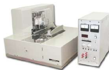
Figura 56 – KES-FB4 Teste de Superfície (Kawabata, 2009)
