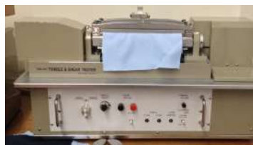
Figura 53 – KES-FB1 Teste de Tração e Corte (Acervo do autor, 2015)
