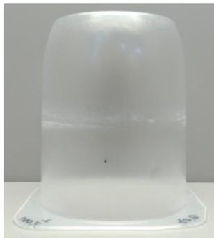
Figura 25 - Copo 1000 µm PET MOD Y, após ensaio de enchimento com água a 90 °C.
