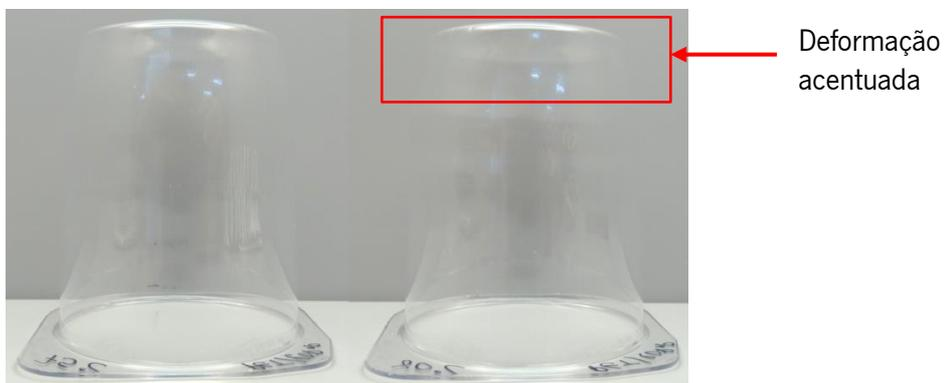
Figura 24 - Copo 900  $\mu\text{m}$  *PET\_base* + 100  $\mu\text{m}$  *PET MOD X*, após ensaio de enchimento com água aos 75 °C e 80 °C, respetivamente.
