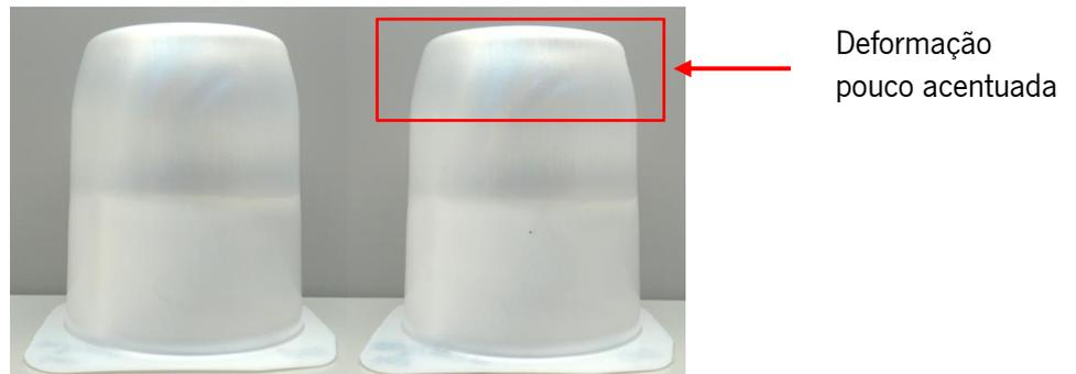
Figura 29 - Copo 500 µm *PET\_base* + 500 µm (50 % *PET\_base* + 50 % *PET MOD Y*), após ensaio de enchimento com água aos 85 °C e 90 °C, respetivamente.
