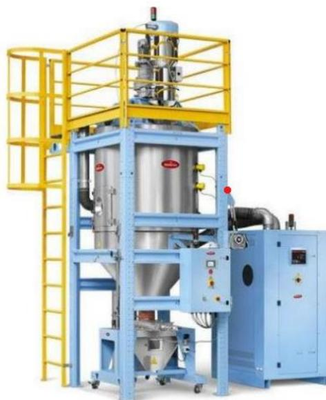
*Figura 8 - Cristalizador e Desumidificador utilizado na secagem das matérias-primas.*
