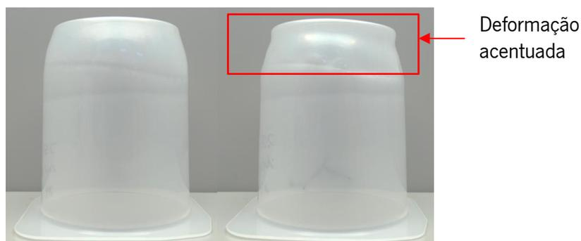
Figura 33 - Copo 90 % PET\_base + 10 % PET MOD Z, após ensaio de enchimento com água aos 75 °C e 80 °C, respetivamente.
