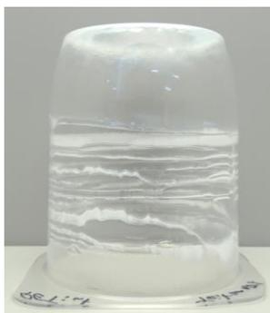
*Figura 27 - Delaminação do copo com 900  $\mu\text{m}$  PET\_base + 100  $\mu\text{m}$  PET MOD Y durante o processo de termoformação.*
