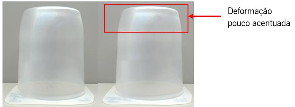
Figura 30 - Copo 500  $\mu\text{m}$  *PET\_base* + 500  $\mu\text{m}$  (75 % *PET\_base* + 25 % *PET MOD Y*), após ensaio de enchimento com água aos 85 °C e 90 °C, respetivamente.
