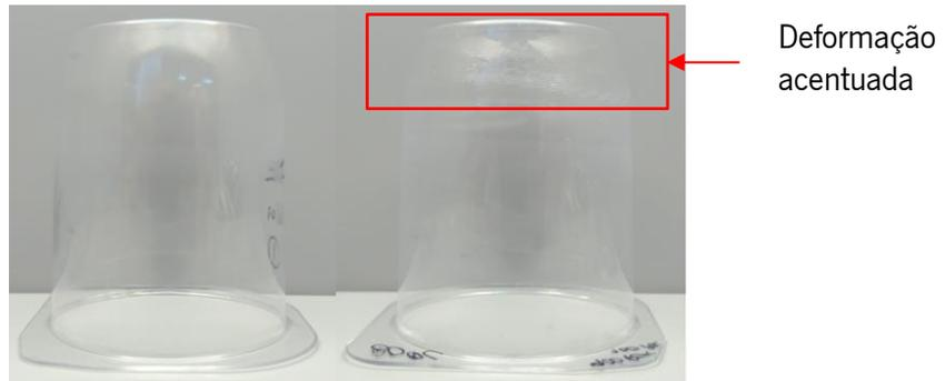
Figura 32 - Copo 900  $\mu\text{m}$  *PET\_base* + 100  $\mu\text{m}$  *PET MOD Z*, após ensaio de enchimento com água aos 75 °C e 80 °C, respectivamente.
