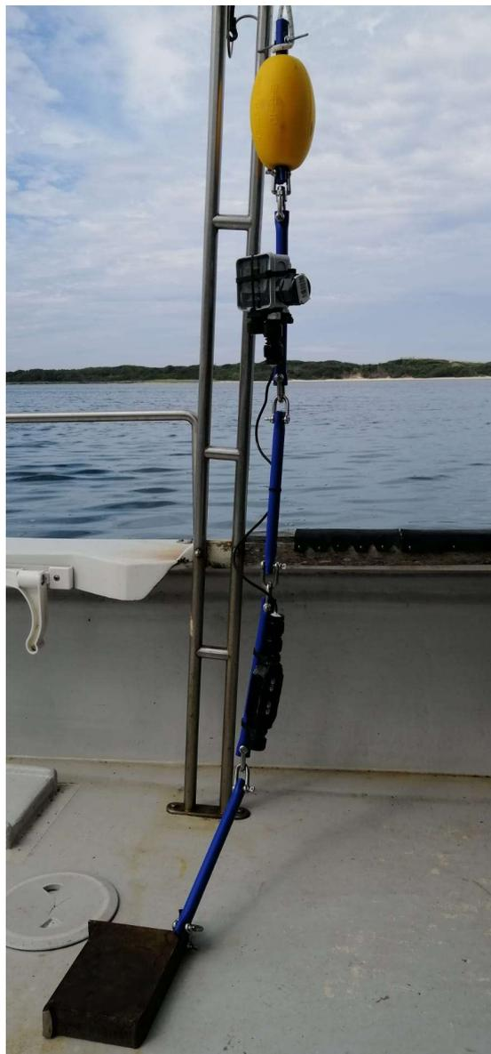
*Figura 5.10 – O sistema do datalogger (acima) e do sensor de salinidade (abaixo) montados na estrutura. Quando instalado no rio, o peso de aço e a boia foram suficientes para manter o sistema esticado verticalmente sem se mover de lugar, mesmo com alguma corrente causada pela descida da maré.*
