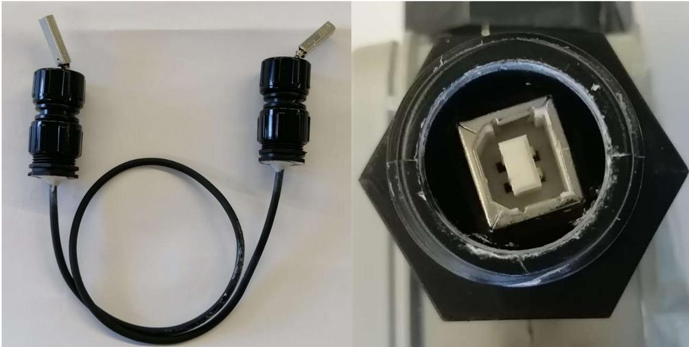
*Figura 5.8 - Cabo de comunicação e energia com conectores USB-B isolados por ligações de PVC à esquerda. Conector USB fêmea do datalogger para comunicação e alimentação com os sensores à direita.*
