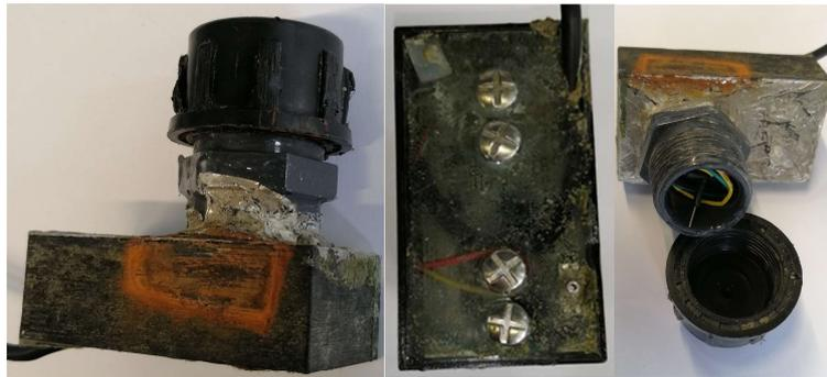
Figura 6.1 – Sensor de salinidade com rosca de PVC que veda os cabos de reprogramação. O sensor apresenta marcas de sujidade e corrosão do período de 3 meses em que esteve a fazer leituras no rio Cávado, mas continua funcional.
