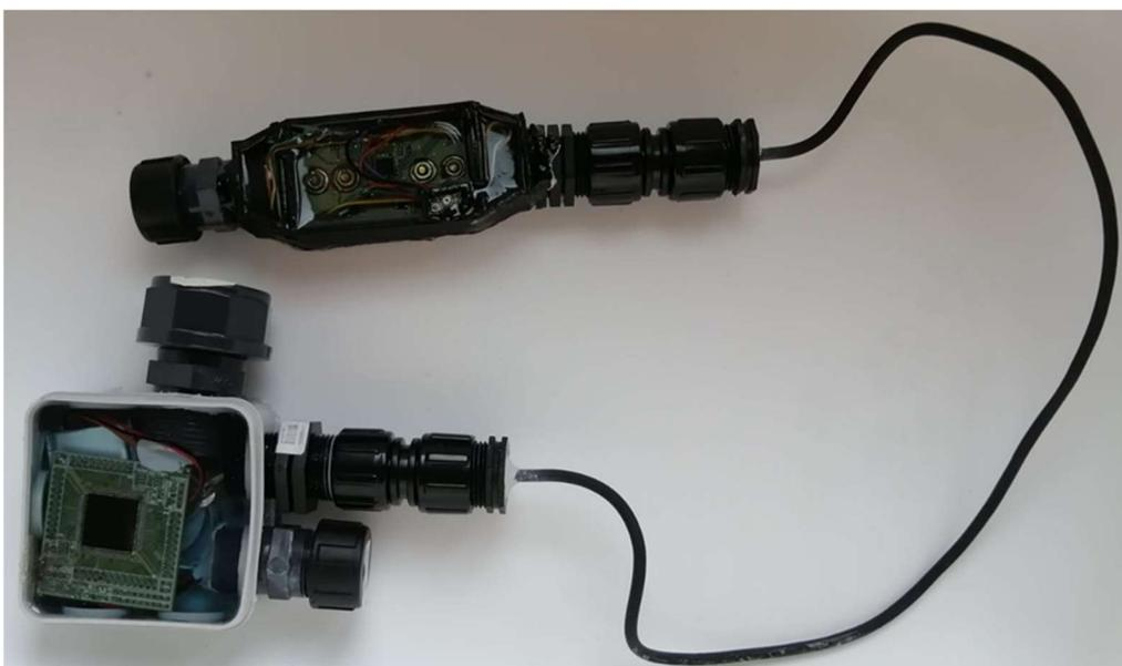
*Figura 5.9 – Datalogger e sensor de salinidade ligados pelo cabo de energia e comunicações, com os conectores de PVC.*
