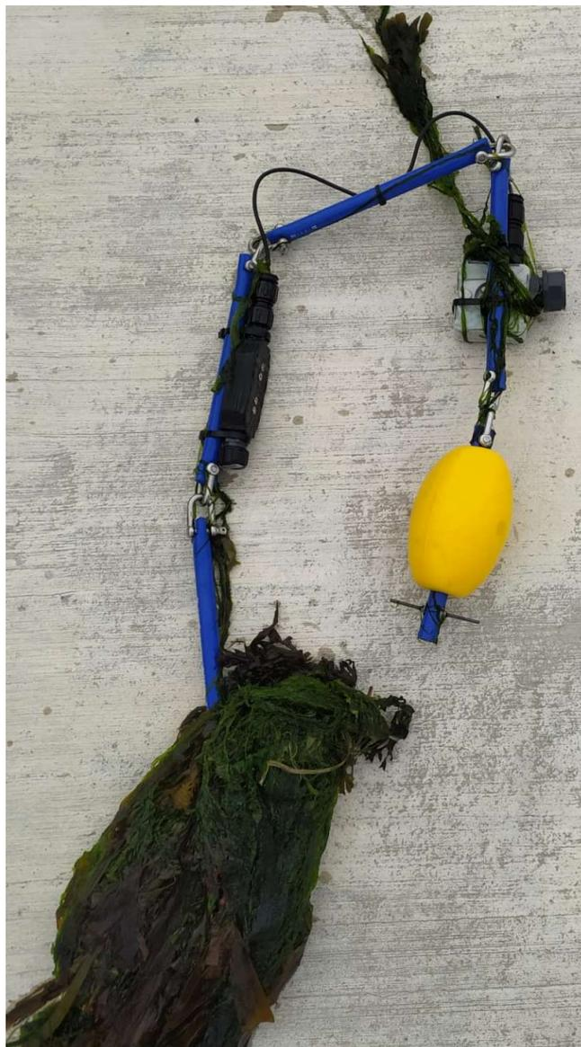
*Figura 6.3 - Sistema de monitorização depois de três dias de teste de campo. A acumulação de algas é visível principalmente no lastro e ligeiramente no datalogger. O sensor manteve-se relativamente limpo.*
