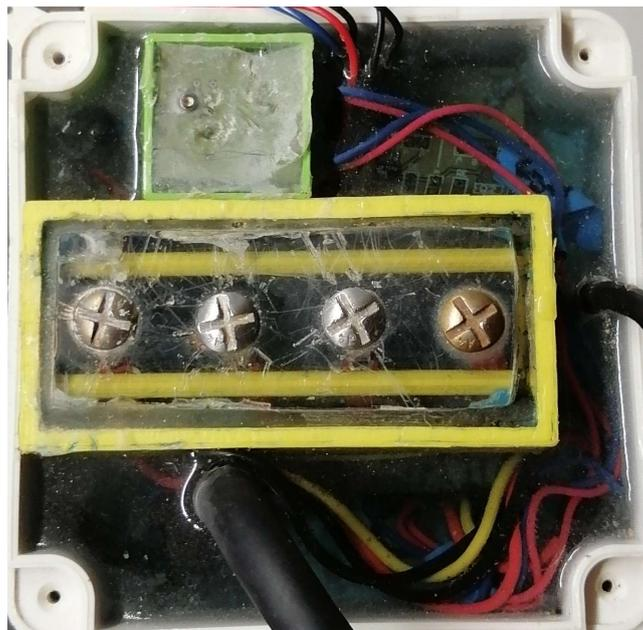
Figura 3.6 - Protótipo do Sistema de Monitorização Marítimo. O módulo amarelo é o sensor de condutividade e a verde o sensor de pressão e temperatura. Os módulos e a eletrônica estão isolados e protegidos por resina epóxi.
