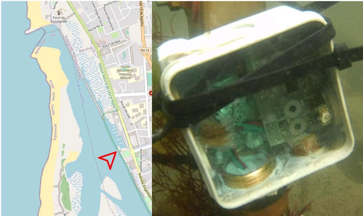
Figura 4.17 - Sensor instalado num suporte metálico preso ao leito do rio Cávado, em Esposende. Mapa base e dados de OpenStreetMap e Fundação OpenStreetMap [32].
