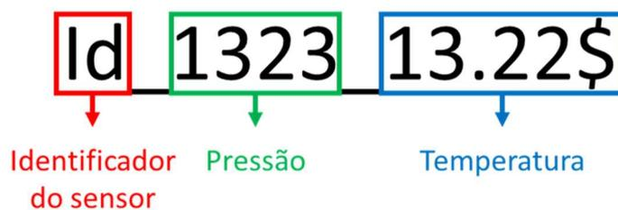
Figura 4.18 - Exemplo de uma trama enviada do sensor para o datalogger.
