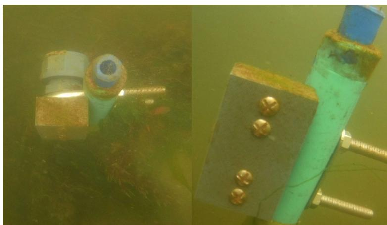
Figura 6.7 - Sensor de salinidade instalado em Esposende ao fim de duas semanas a adquirir dados de salinidade, temperatura e pressão. À esquerda a perspectiva de cima do sensor, onde as algas que se depositam na estrutura de suporte são visíveis. À direita a perspectiva de frente.
