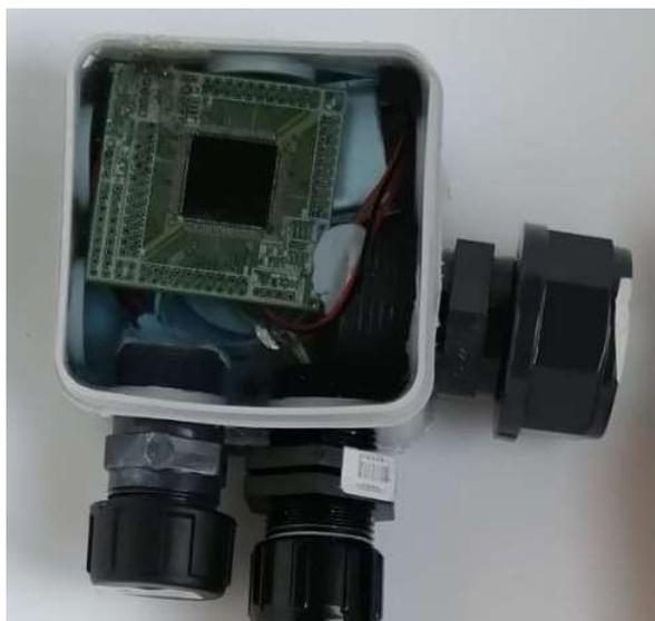
*Figura 5.3 – Datalogger usado nos testes submersos em Esposende. Nesta fase, a eletrônica já está envolvida em resina epóxi.*
