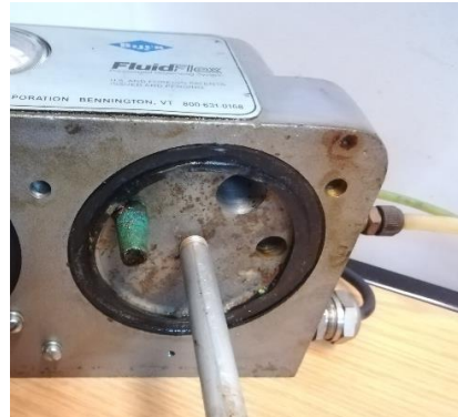
Figura 5.34 - Pormenor do vedante danificado.
