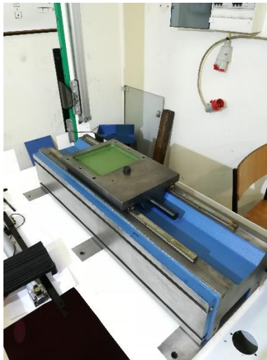
Figura 5.24 - Barramento e carro do eixo X depois de limpos e escovados.
