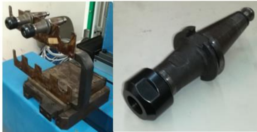
Figura 4.4 -Carregador de ferramentas tipo "Rack" (à esquerda) e cone porta ferramentas (à direita).
