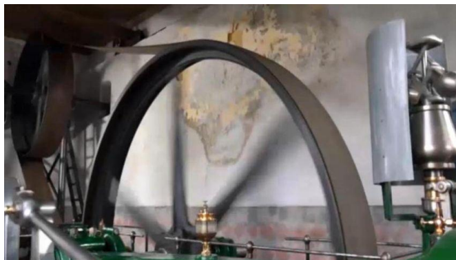
Figura 3.3 - Máquina a vapor acionando o eixo de linha [19].
