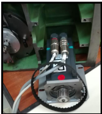
35º Ligação dos cabos do motor e sua fixação à estrutura do eixo B.
