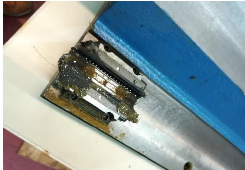
Figura 5.19 Patim do carro longitudinal evidenciando a ausência de lubrificação e a contaminação por pó de MDF.
