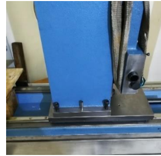
Figura 5.27 - Fixação da coluna através de parafusos e alinhamento por pinos guia.
