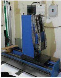
Figura 5.26 - Montagem da coluna e do carro do eixo Y.
