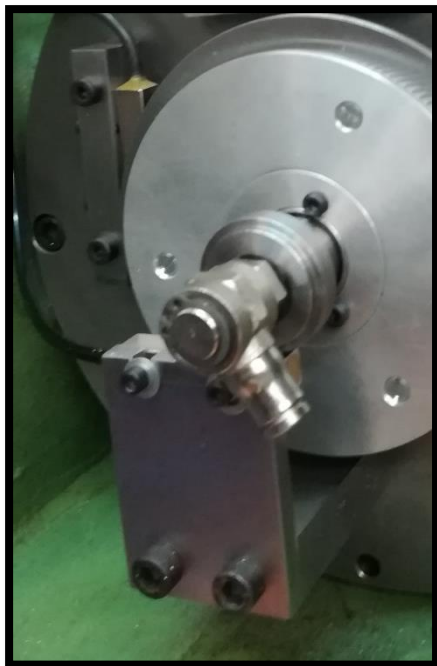
33º Montagem do sensor indutivo (atuado pelo anel observado anteriormente) e do seu suporte em “L”.
