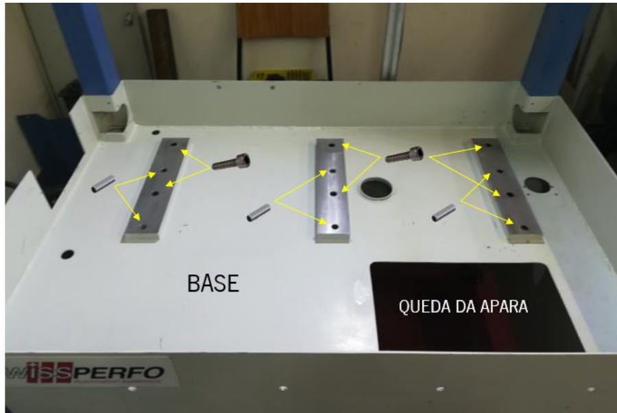
Figura 4.5 - Estrutura do Centro de Maquinagem, em aço, e localização das ligações aparafusadas do barramento.
