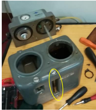
Figura 5.33 - Unidade de fluido de corte.
