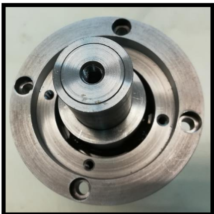
2º Inserir o anel espaçador do veio do sem fim.
