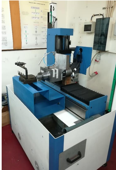
Figura 5.40 - Centro de maquinagem após requalificação.
