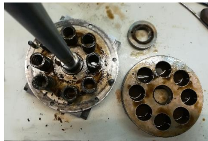
Figura 5.16 - Desmontagem do prato do sistema pneumático.
