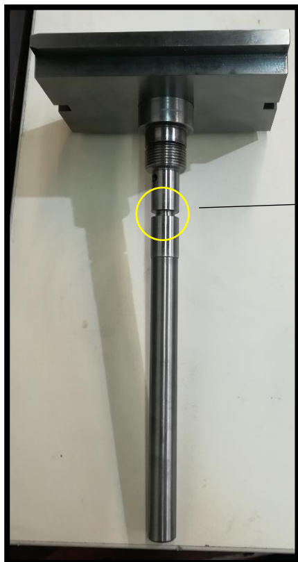
17º Montagem do veio oco na mesa do eixo B. Visto de trás.
