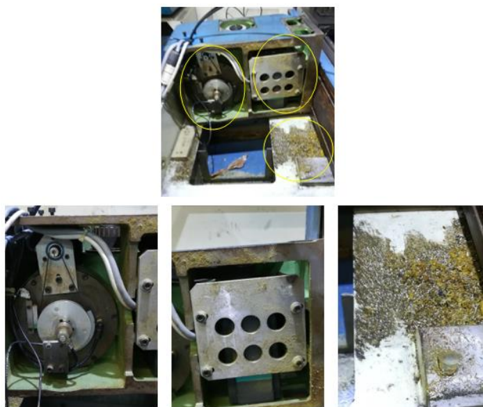
Figura 5.11 - Etapa da remoção do eixo B e o seu estado de conservação.
