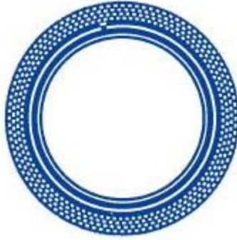
Figura 3.8 – Exemplo de um disco de um codificador ótico incremental [30].
