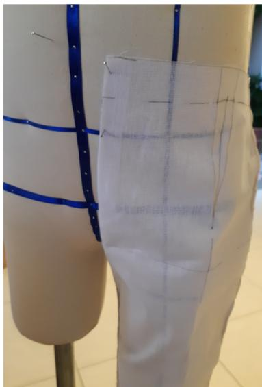
**Figura 110** - Validação da calça desenvolvida com a modelação do CITEX.
