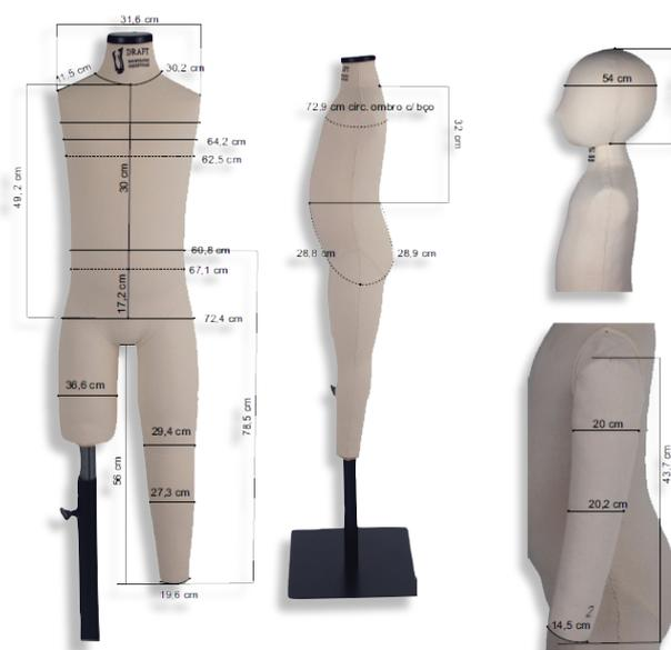
**Figura 44** - Ficha Técnica – Desenho Técnico e Medidas do Grupo 2 (Altura 130 cm, Massa corporal 28,3 kg), elaborada pela empresa de MANEQUINS INDUSTRIAIS, (2018)
