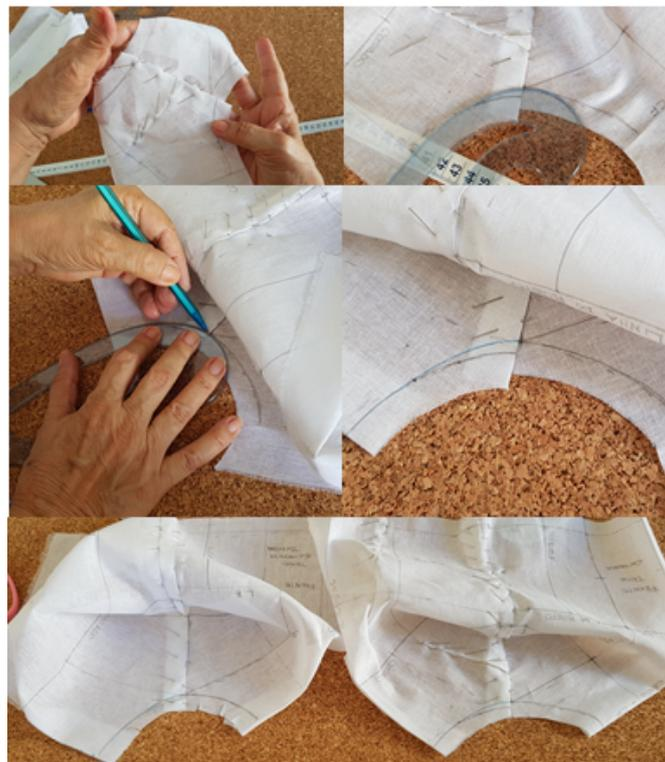
**Figura 67** – Correções da montagem da Blusa com Alfinetes.
