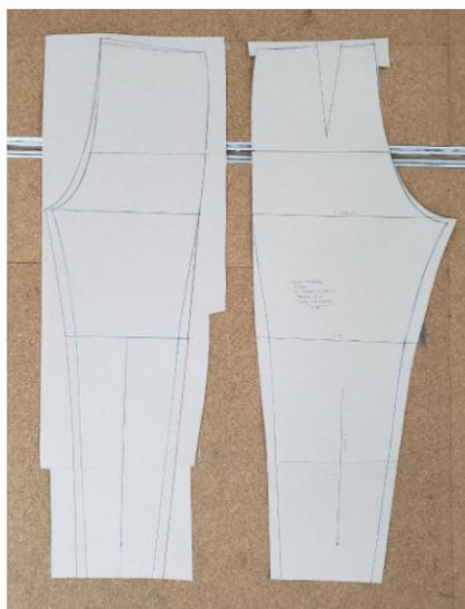
**Figura 124** - Correções dos moldes base da calça comprida, frente e costas.
