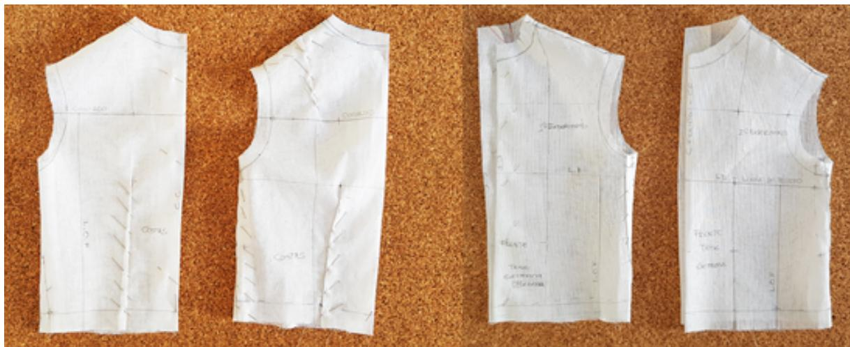
**Figura 68** – Base da Blusa Frente e Costas, montada com alfinetes - Primeira (esquerda) e Segunda (direita) Experiências.
