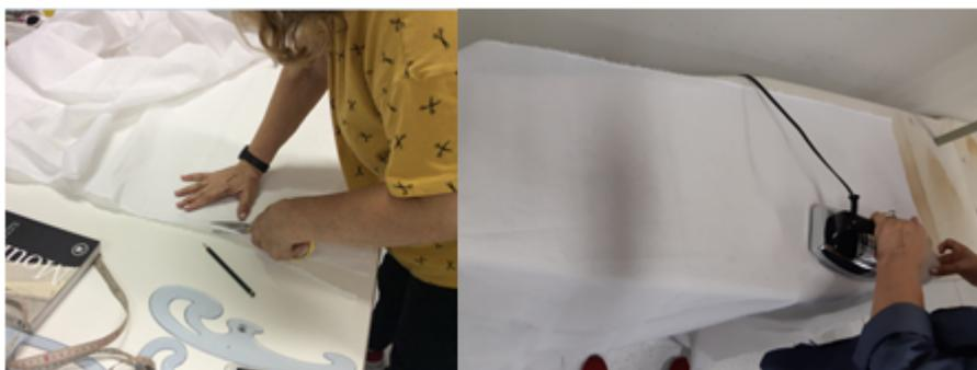
**Figura 51** – Preparação do tecido - Remoção da ourela e passagem a ferro.
