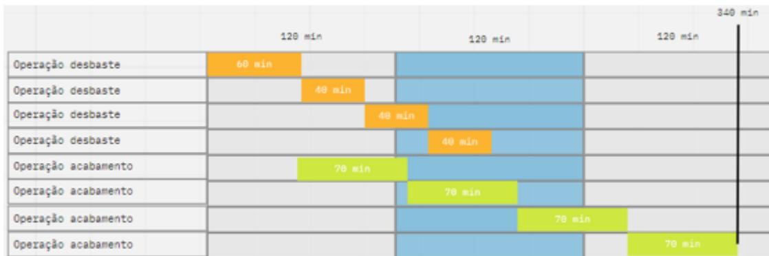
Figura 28 - Diagrama de produção por one-piece-flow barras em bruto
