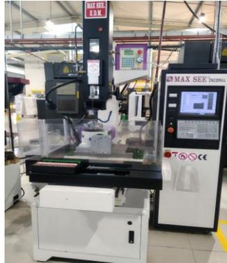
*Figura 21 - Máquina furação EDM*
