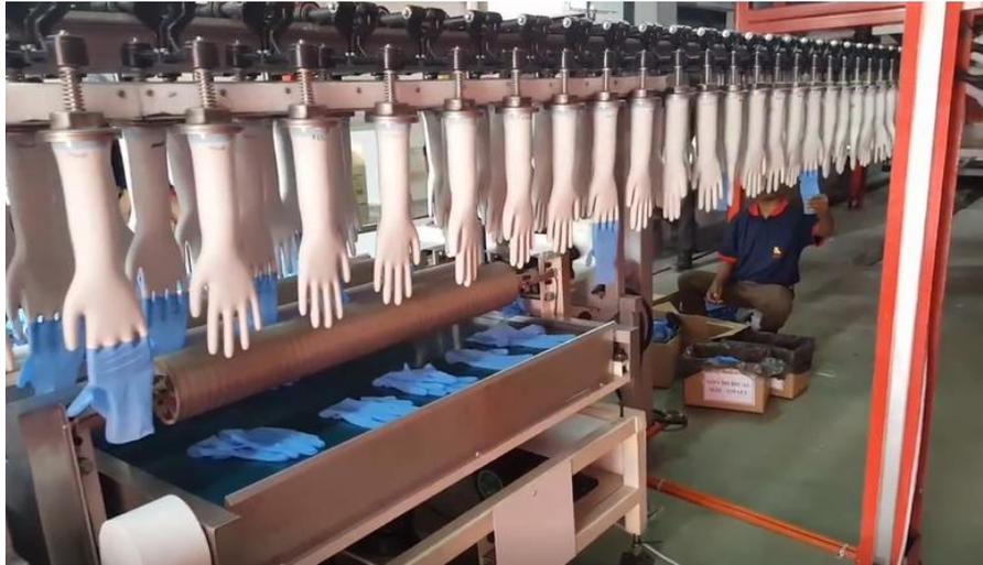
*Figura 19 - Uso de mão-de-obra para solucionar problemas do equipamento de descalçar total (Yicheng Machinery, 2016).*
