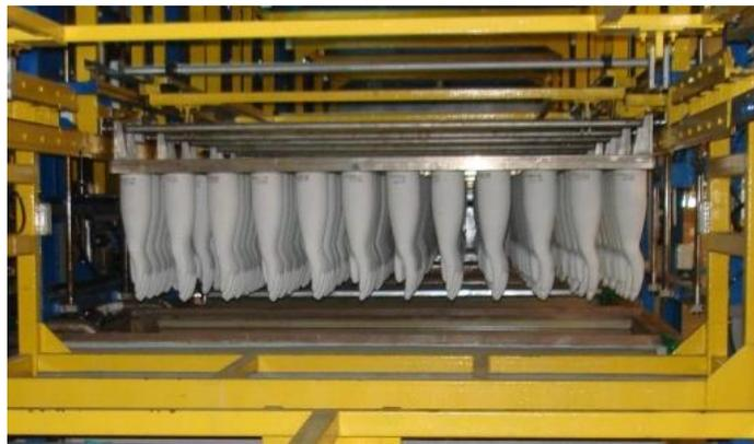
*Figura 7 - Sistema automático em lote utilizado no processo de produção de imersão por coagulante (COSMOS ENGINEERING MALAYSIA, 2020).*
