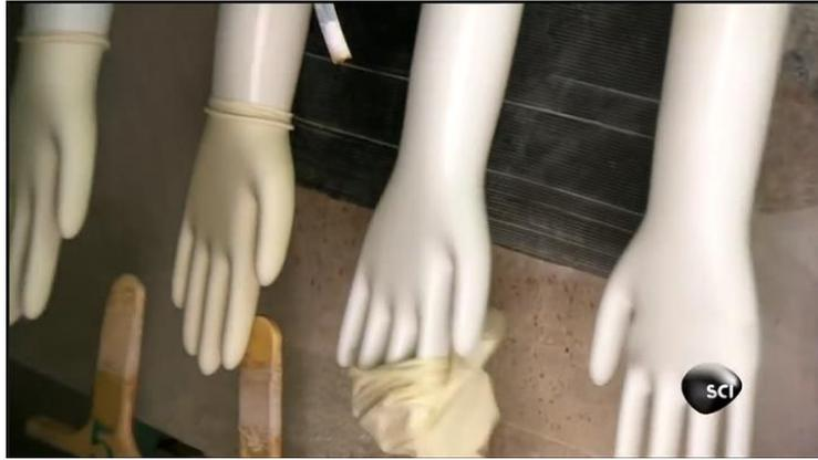
Figura 20 - Equipamento de descalçar total para sistemas automáticos em lote (IMGSA GROUPE, 2016).
