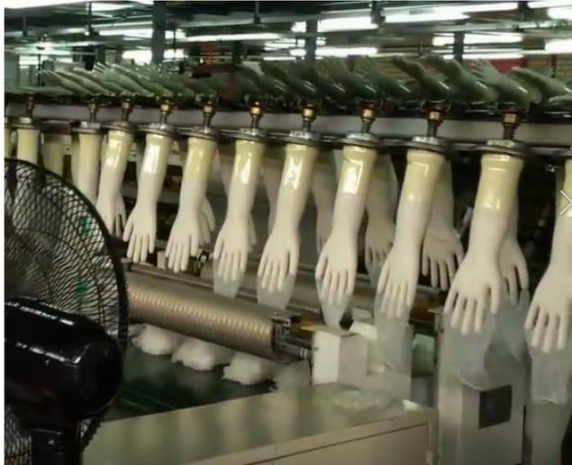
Figura 17 - Equipamento de descalçar total para sistema automático em linha. (Nguyen Minh, 2017)
