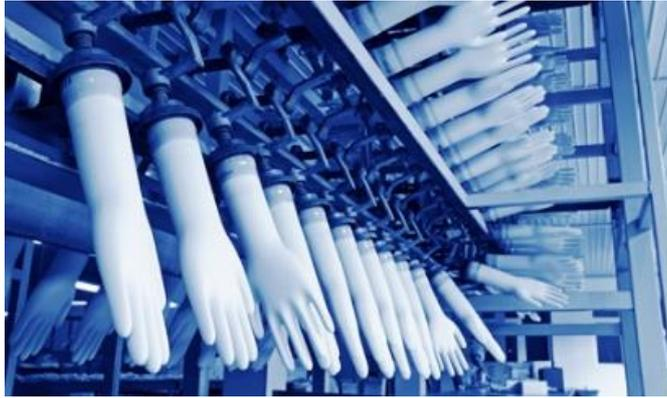
*Figura 6 - Sistema automático em linha utilizado no processo de produção de imersão por coagulante (LAVANITRAS SDN BHD, 2016).*
