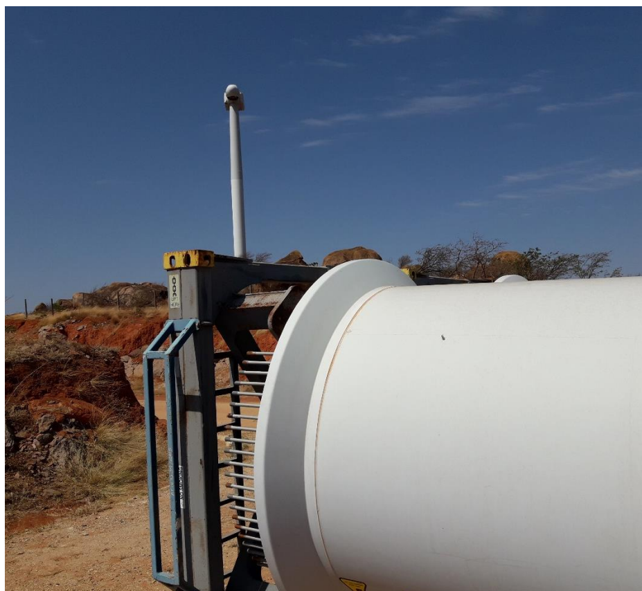
Figura 113: Estruturas (pá) de um aerogerador em Igarorã. Fonte: Autor (2019).
