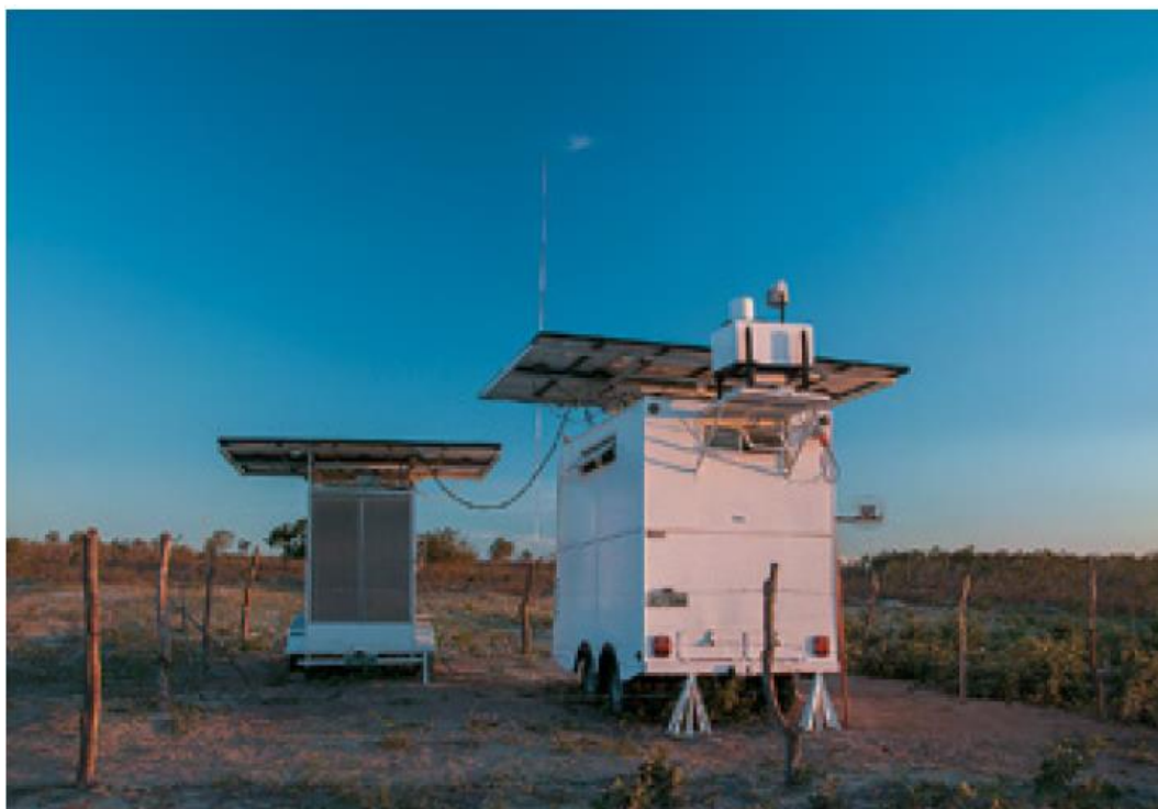
Figura 28: Equipamento LIDAR instalado sobre trailer de transporte em operação. Fonte: BAHIA, (2013), foto de Zig Koch.
