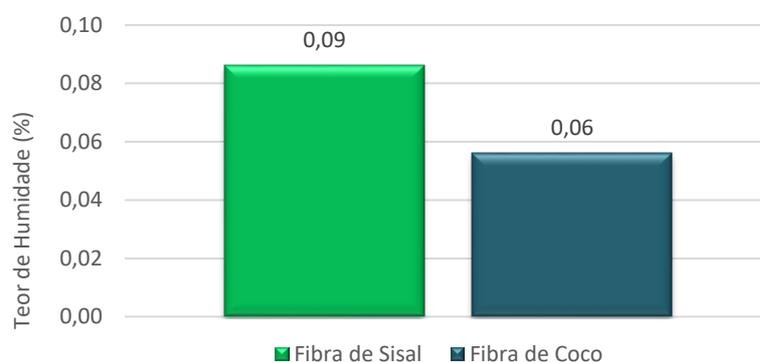
**Figura 31:** Resultados obtidos na avaliação do teor de humidade presente nas Fibras de coco e de sisal de comprimento de 1000  $\mu\text{m}$  utilizadas para reforçar os filmes compósitos.
