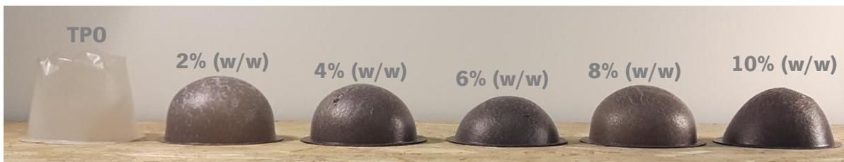
**Figura 60:** Bolhas enformadas a partir do processo de termoformação das folhas compósitas com fibras de coco de comprimento de 1000  $\mu\text{m}$ .
