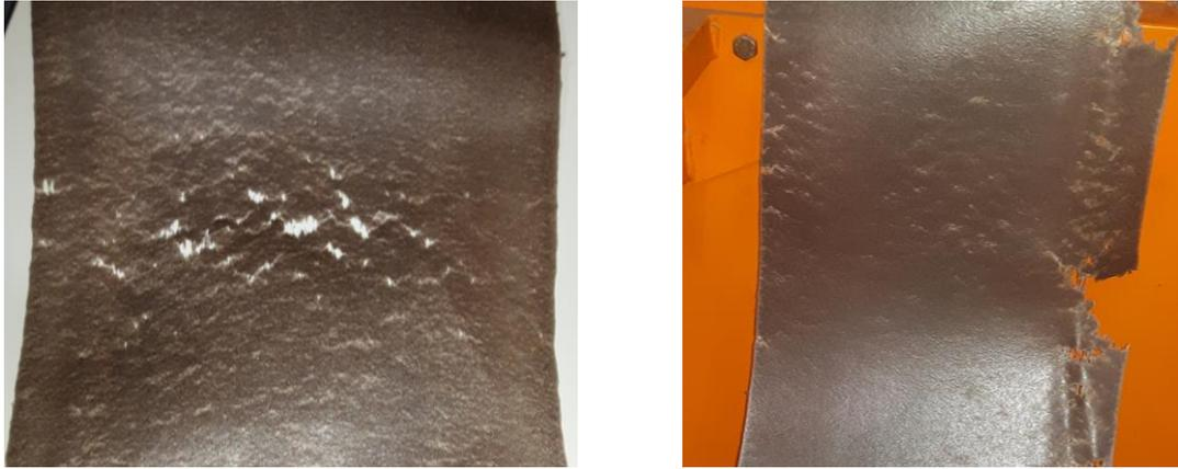
**Figura 21:** Defeitos apresentados na folha compósita com 15% de Sisal 1000  $\mu\text{m}$ .
