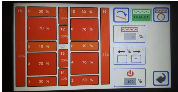
**Figura 29:** Taxa de aquecimento de cada zona do forno da termoformadora.
