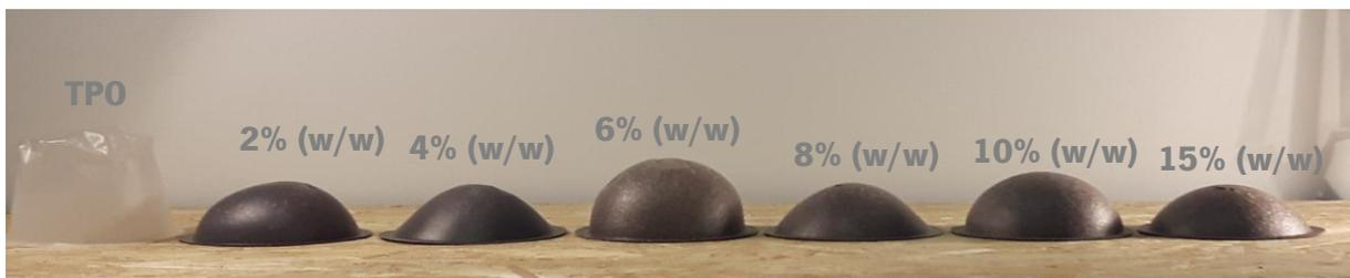
**Figura 61:** Bolhas enformadas a partir do processo de termoformação das folhas compósitas com fibras de coco de comprimento de 500  $\mu\text{m}$ .
