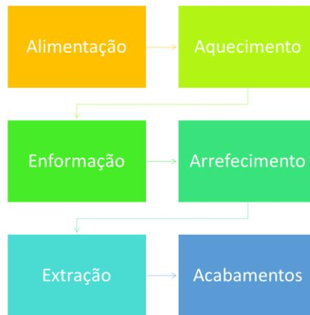
**Figura 8:** Etapas do processo de Termoformação.
