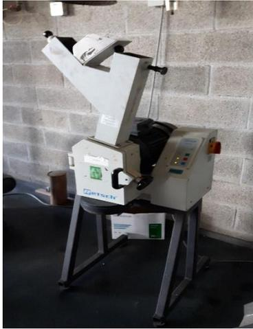
**Figura 13:** Moinho de facas utilizado no corte das fibras naturais.
