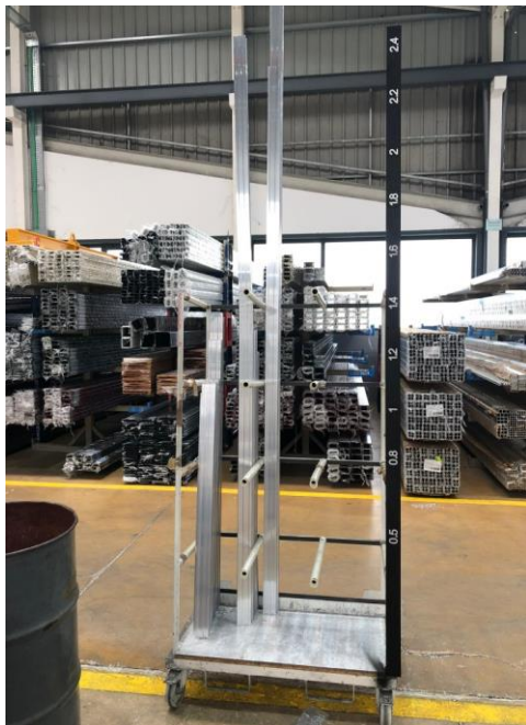
Figura 36 - Proposta final de alteração do carrinho de sobras
