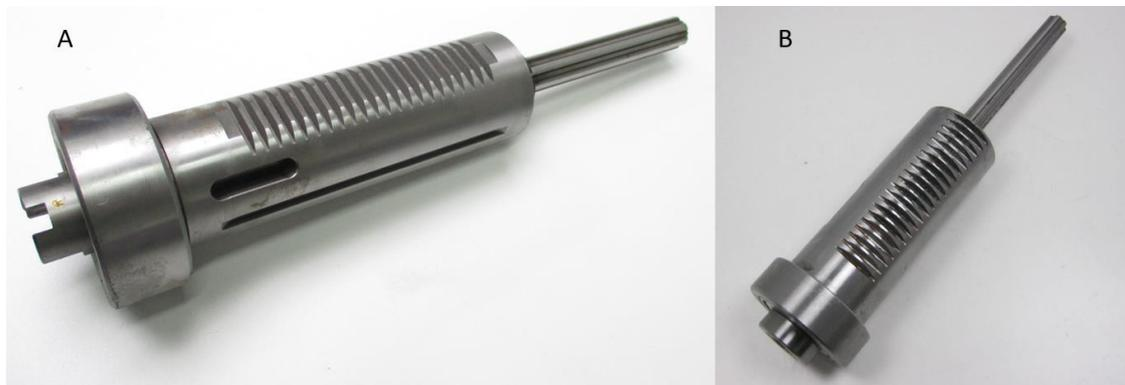
Figura 10 – Tipos de árvore utilizadas nos engenhos de furar
