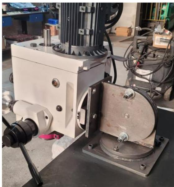
*Figura 16 – Ferramenta com cabeçote de engenho de furar DH40 G montado para manutenção*
