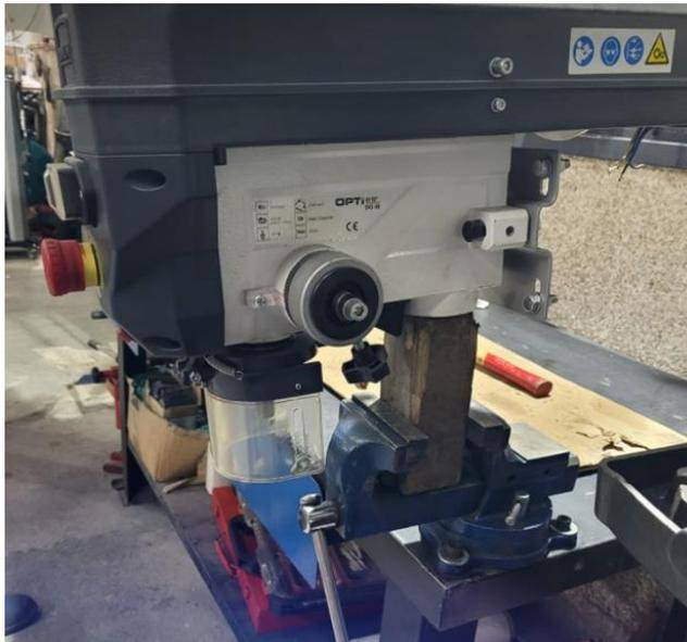
*Figura 15 – Exemplo fixação improvisada de um cabeçote de engenho de furar de correias DQ 18*
