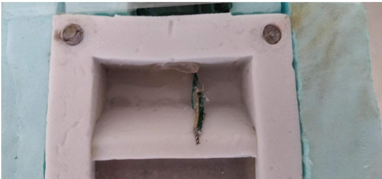
*Figura 37 - Posicionamento do termopar da água de saída*
