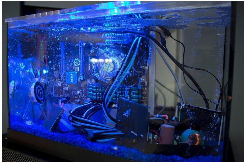
*Figura 4 - Sistema de arrefecimento por imersão*
