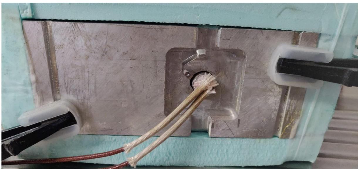
*Figura 39 - Resistência de cartucho instalada no bloco de aquecimento*
