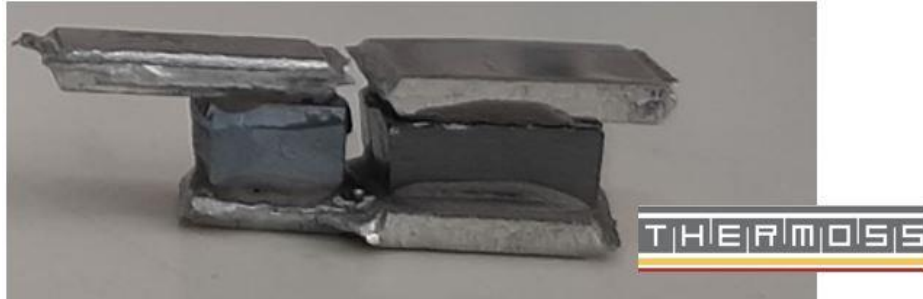
Figura 28 - Gerador termoelétrico desenvolvido pelo projeto THERMOSS (conectores de alumínio e elementos termoelétricos de tetrahedrite e siliceto de magnésio).
