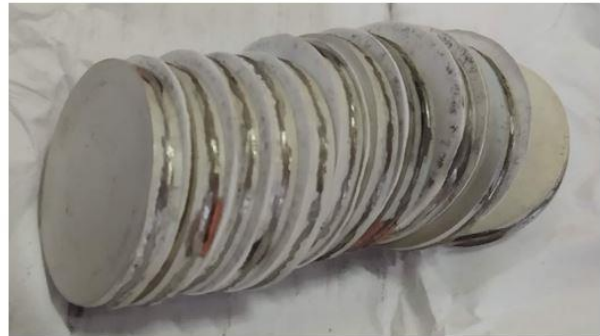
Figura 27 - Elementos termoelétricos usualmente utilizados (à esquerda) e elementos termoelétricos personalizados (à direita) [30].
