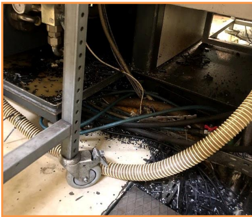
Figura 26- Fugas de óleo e falta de limpeza na máquina
