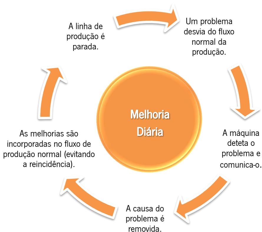
Figura 4- Conceito do Jidoka (Fonte: Elaboração própria. Adaptado de Shingo, 1981)
