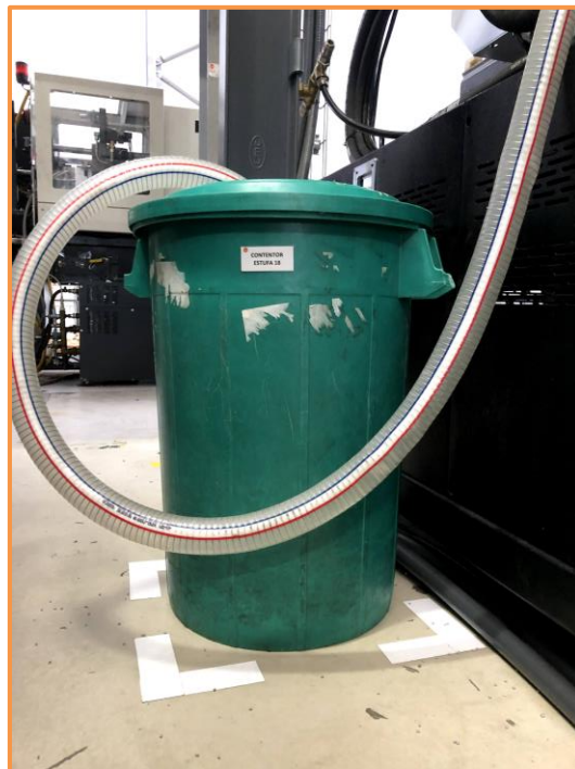
Figura 25- Delimitação do local onde se deve manter o contentor de MP junto à máquina
