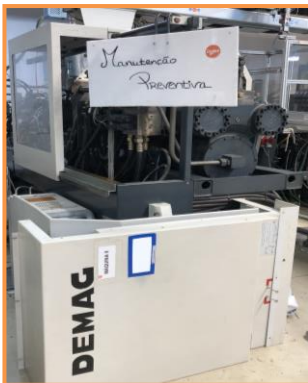
Figura 28- Sinalização de alerta da Manutenção Preventiva
