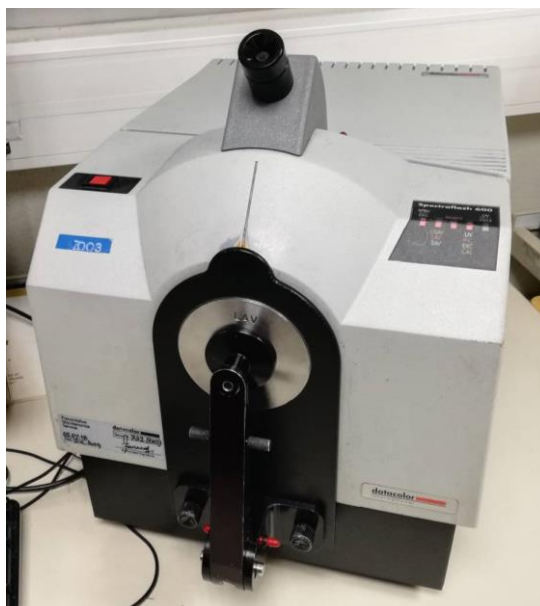
Figura 16 - Espectrofotômetro DataColor SF 600 Plus- CT utilizado para a leitura de amostras já tingidas.
