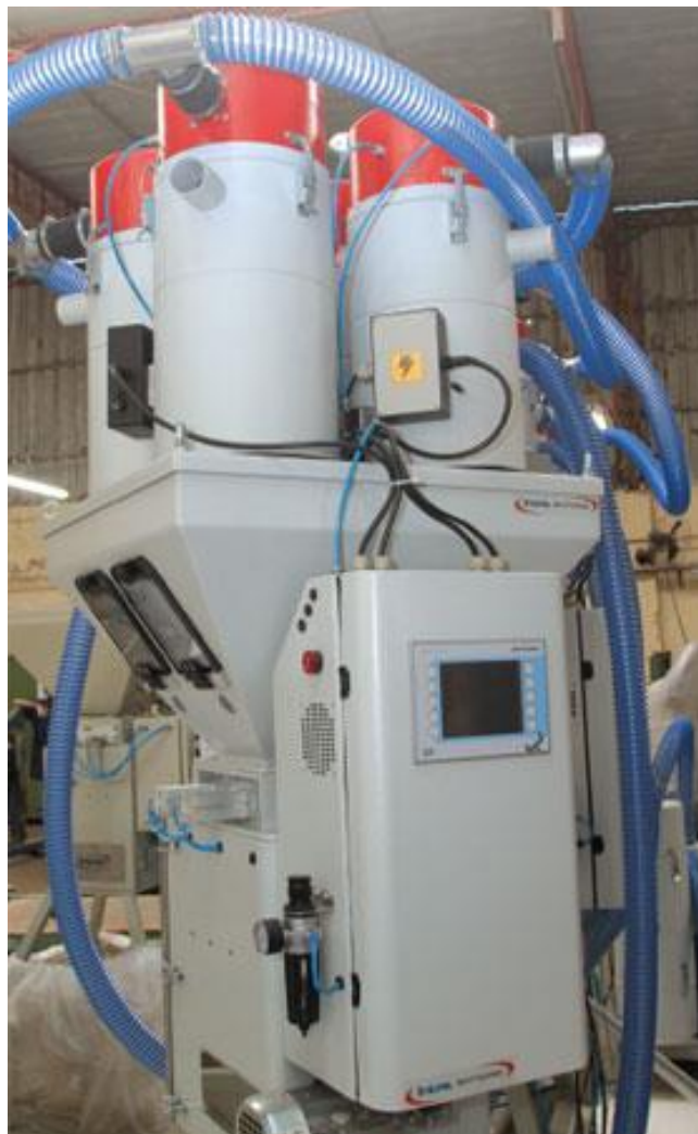
Figura 28 - Máquina de mistura e dosagem de granulado de plástico
