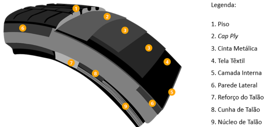
Figura 4 - Exemplo constituição do pneu
