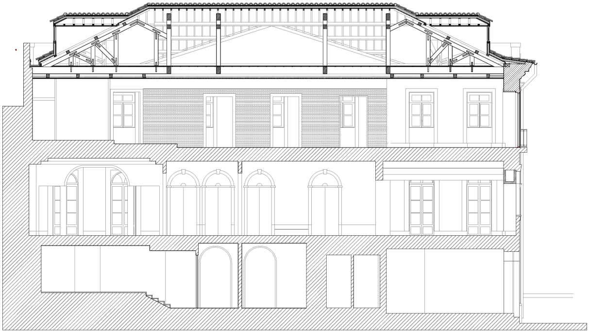
Figura 97: Corte Longitudinal da cobertura em madeira proposta para a Casa Martins Sarmento;
