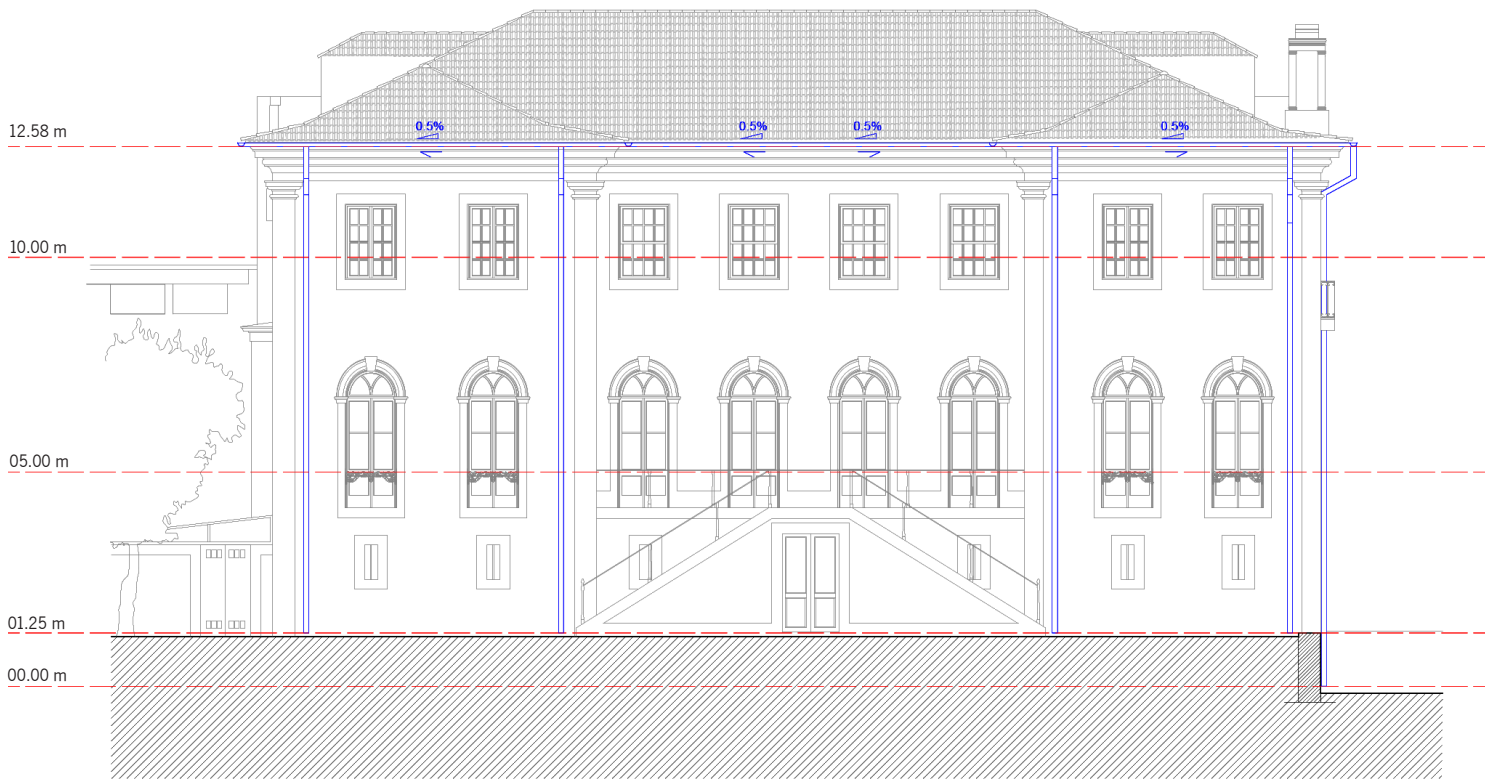
Figura 107: Alçado poente da Casa Martins Sarmento com a representação do sistema de escoamento de águas.
