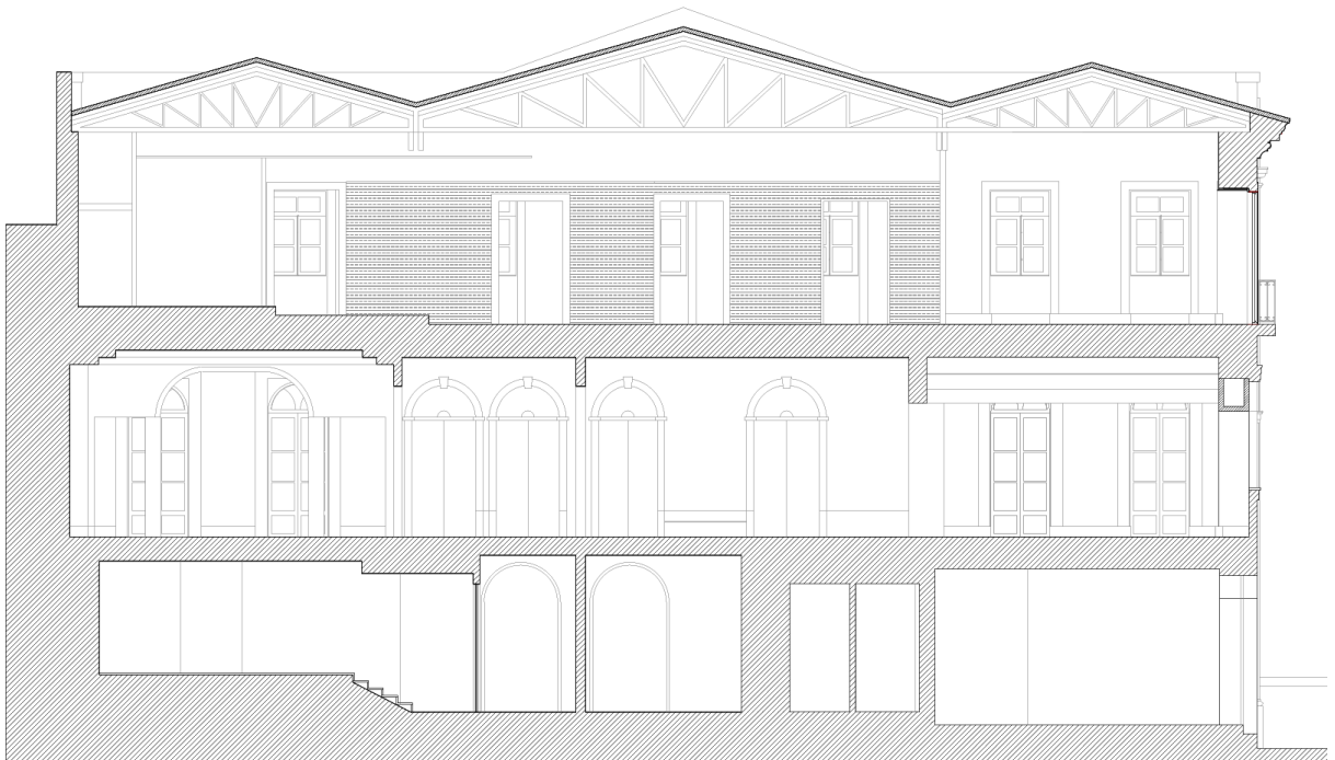
Figura 88: Corte longitudinal da cobertura provisória realizada com uma estrutura metálica da Casa Martins Sarmento;
