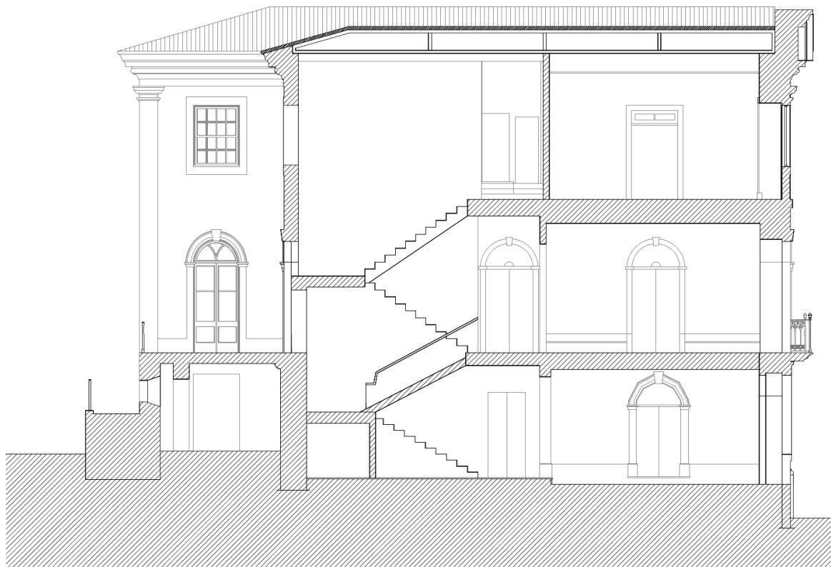
Figura 91: Corte transversal da cobertura original em madeira da Casa Martins Sarmento;
