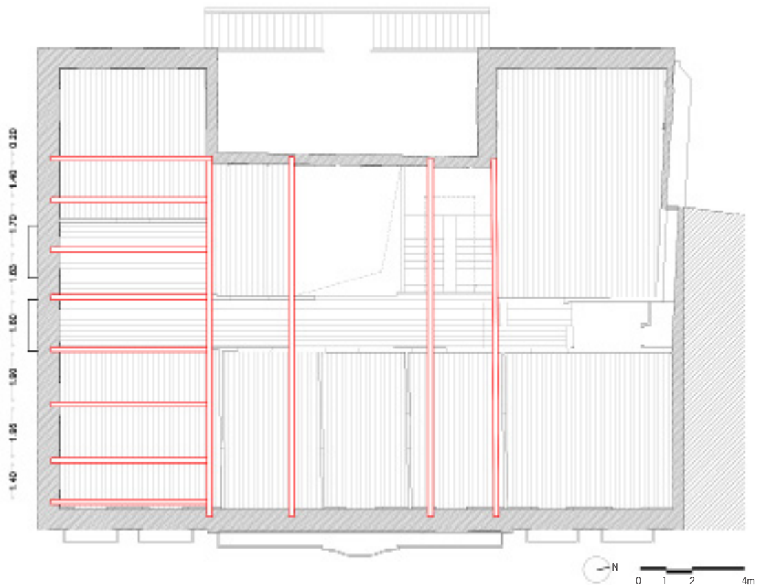
Figura 60 : Planta com o mapeamento das asnas visíveis na casa;
