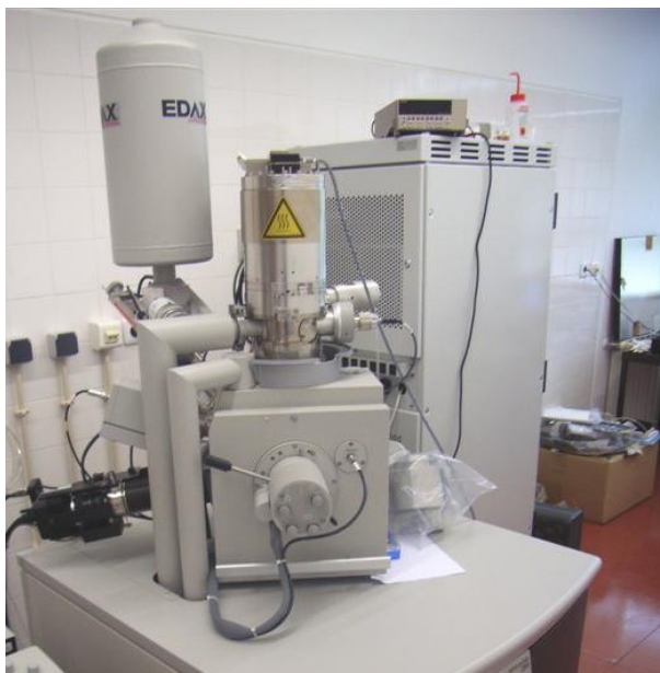
Figura 18- Equipamento Microscópio Eletrónico de Varrimento de ultra elevada resolução utilizado na caracterização das amostras têxteis.
