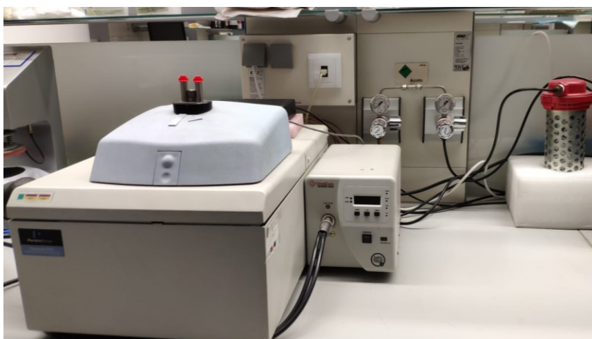
Figura 19- Equipamento Calorimetria Diferencial de Varrimento (Perkin Elmer com um ILP Intracooler) utilizado na caracterização das amostras funcionalizadas.
