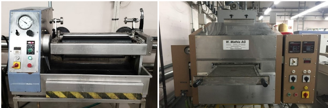
Figura 15- Equipamento fouldard (Mathis) utilizado na funcionalização têxtil e secadeira (W.Mathis AG) usada para a secagem das amostras.
