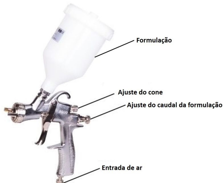
Figura 8-Pistola de Pulverização para aplicação de formulação por spray pneumático. Adaptada de (Landsberg, 2018).
