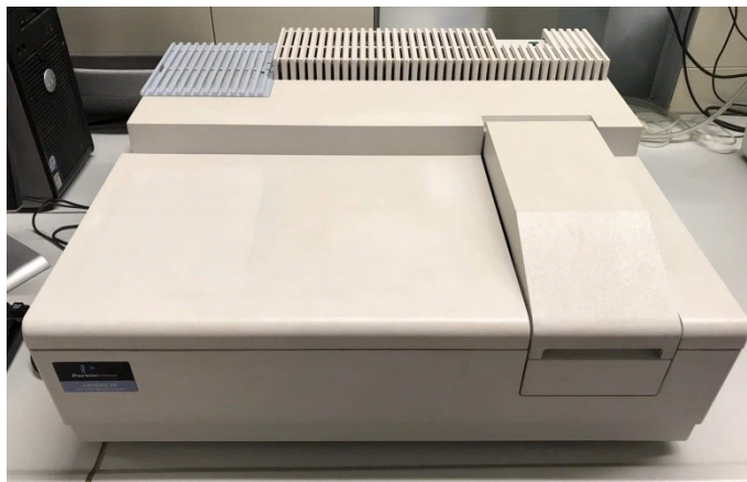
Figura 21- Representação do espectrofotómetro Perkin Elmer Lambda 35 de duplo feixe.
