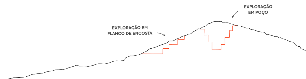
Ilustração 29 - Tipos de exploração de granito: exploração em flanco de encosta e exploração em poço
