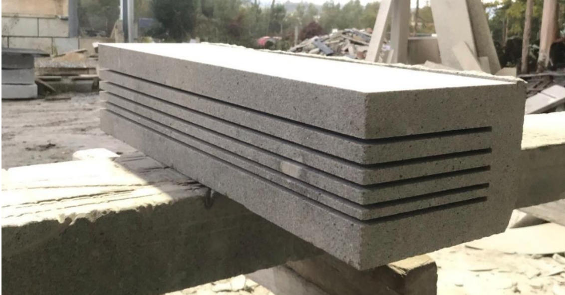
Ilustração 93 - Rasgos realizados a engenho mecânico
