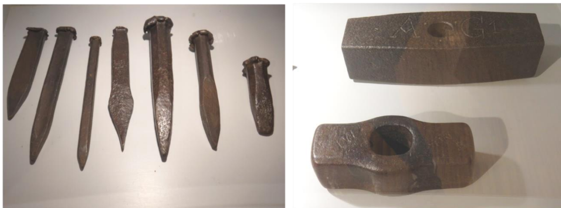
Ilustração 34 - Diferentes tipos de cunhas de aço e duas cabeças de marreta de aço. NUNES, Alessandro. Fotografias tiradas em: Museu do Canteiro, Alcains - Castelo Branco (2021)
