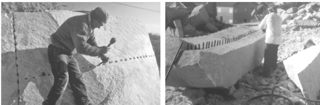
Ilustração 35 - Cabouqueiro a abrir blocos de pedra. NUNES, Alessandro. Fotografias tiradas em: Museu do Canteiro, Alcains - Castelo Branco (2021)
