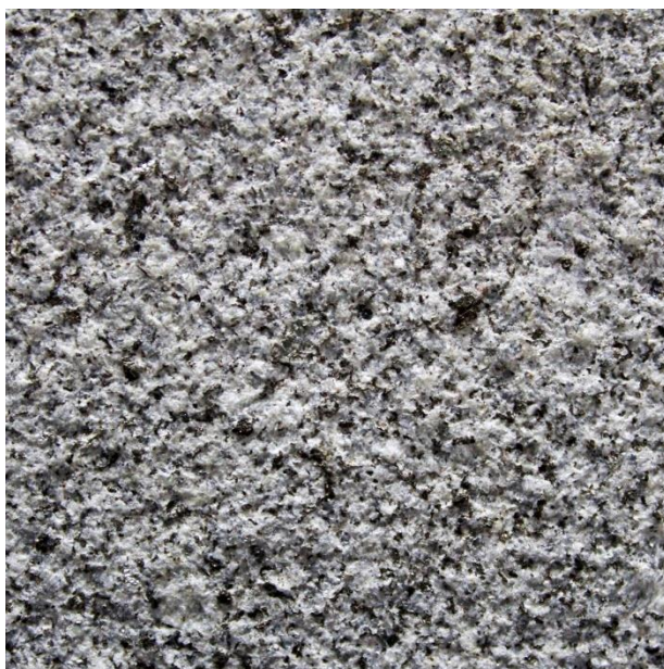
Ilustração 69 - Acabamento granalhado, NITAL. Acabamentos, Nital
