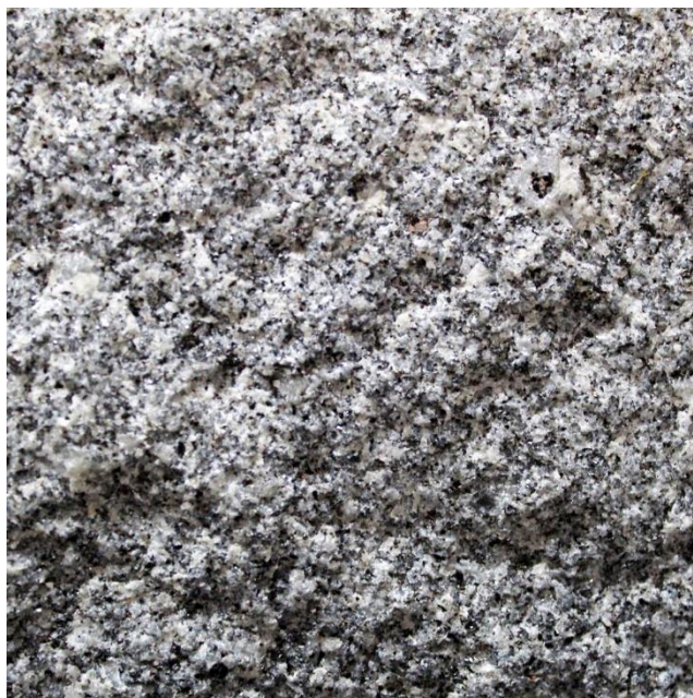
Ilustração 70 - Acabamento rachado, NITAL. Acabamentos, Nital
