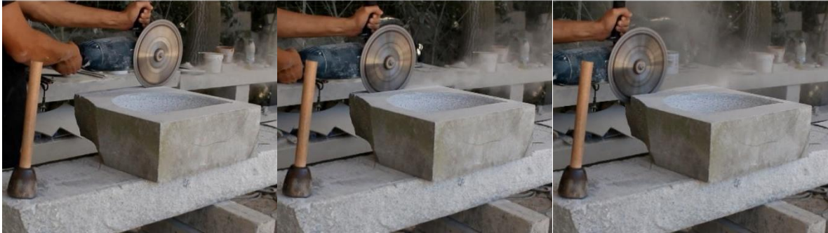
Ilustração 90 - Técnica de corte com a rebarbadora
