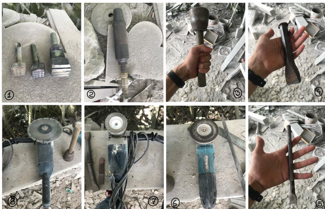
Ilustração 78 - Ferramentas de corte e desbaste: 1) Bujardas; 2) Bujardadora; 3) Macete; 4) Escassilhadeira; 5) Cinzel; 6) Rebarbadora com mó de carvão; 7) Rebarbadora com mó de diamante; 8) Rebarbadora com disco de corte
