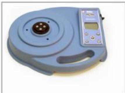
**Passo 2:** Alinhar a placa superior com o acoplamento do torque. O botão de fixação está posicionado à esquerda;
