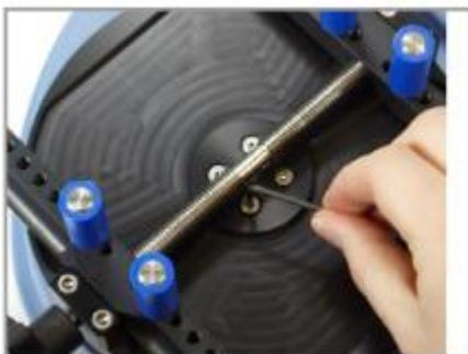
**Passo 4:** Para utilizar o torquímetro com o botão de fixação na frente, repetir os passos 1 a 3, mas posicionar a placa superior diferente, durante o passo 2.
