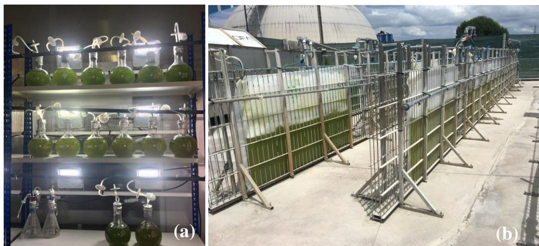
**Figura 8.** Diferentes reatores de crescimento de culturas: (a) reatores de 2 L (balões de vidro); (b) reatores de 50 L (PP).
